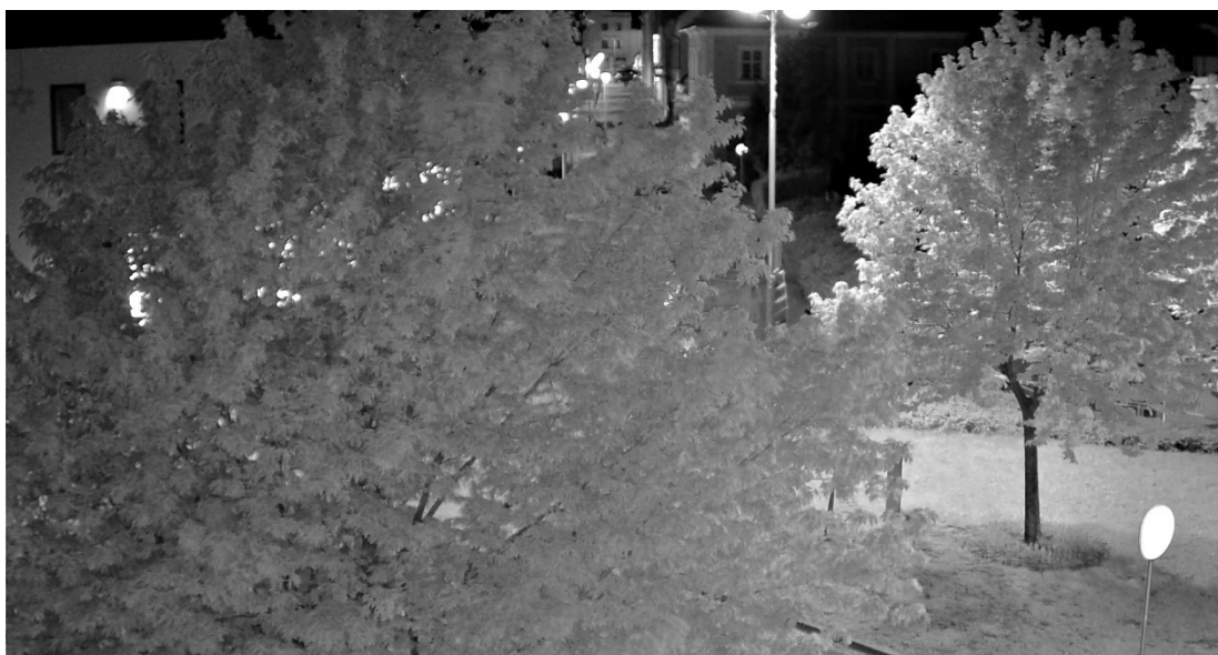
Obrázek 15 – Nevhodné umístění kamer podle nejednoznačného zadání a absence kamerové zkoušky
