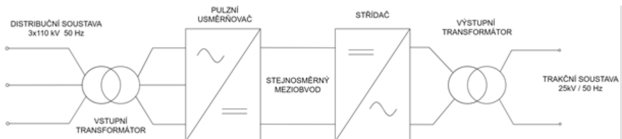
Obr. 1 Blokova struktura měničové napájecí stanice
