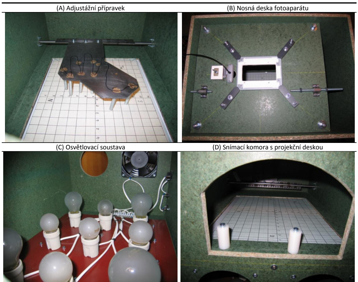
Obrázek (4.4) Vlevo nahoře -adjustážní přípravek pro přesné umístění ruky. Vpravo nahoře -nosná deska fotoaparátu. Vlevo dole -osvětlovací soustava tvořená 9-ti žárovkami (40W a 25W). Vpravo dole -snímací komora.
