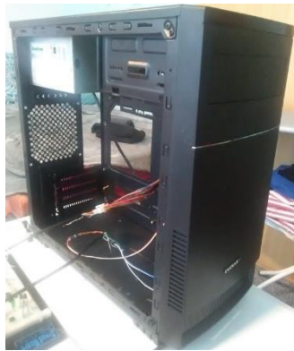
Obrázek 2.1 – Počítačová skříň se zdrojem ATX standardem
