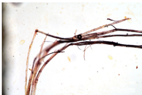
Obrázek 1 Vlákniňové složení vzorku AP_2, Herzbergova zkouška.
