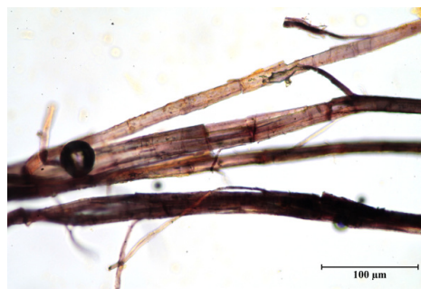
Obrázek 2 Vlákniňové složení vzorku AP_2, Herzbergova zkouška.
