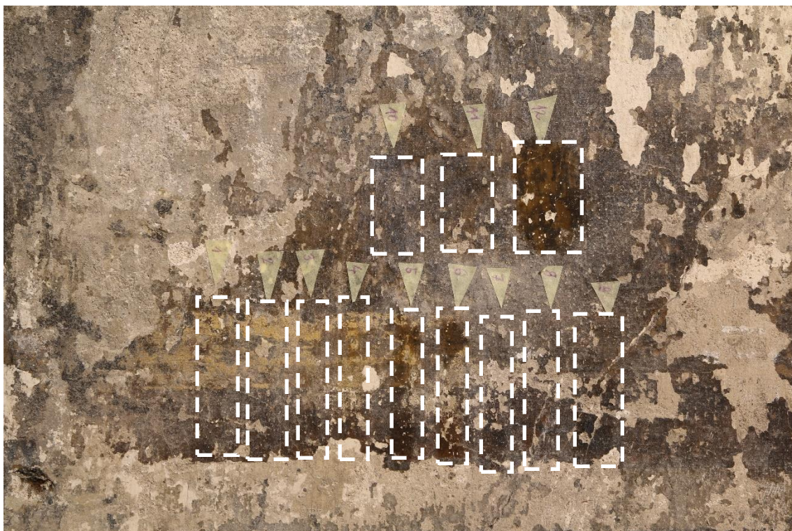
Obrázek 19: Zkoušky čištění: 1– voda, 2– technický líh, 3– aceton, 4– White Spirit, 5– toluenové rozpouštědlo, 6– xylén, 7– 1% citrát amonný, 8– 2% citrát amonný, 9– 5% citrát amonný, 10– 5% uhličitan amonný, 11– Saliva syntetická, 12– toluén v gelu kyseliny polyakrylové (Carbopol EZ2)
