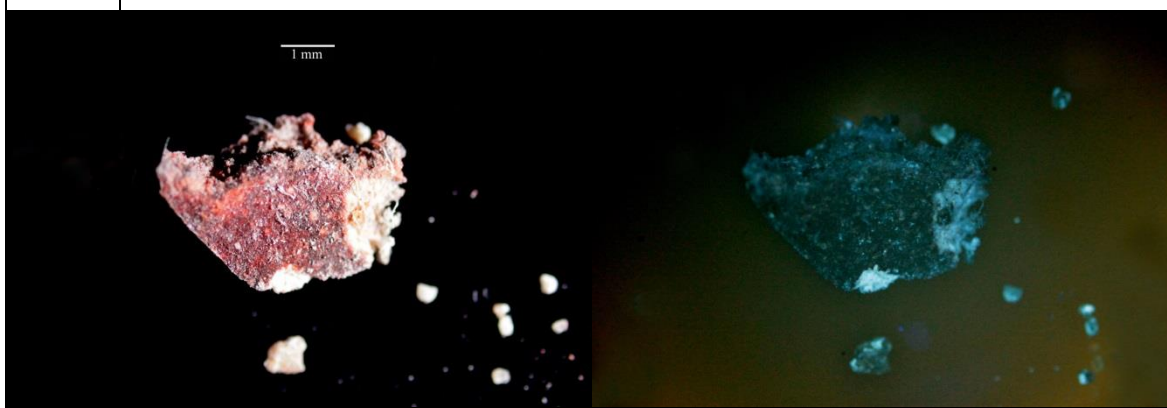
Obr. 42, 43 Optická mikroskopie, vzorek z vrchní strany, bílé světlo, UV fluorescence.
