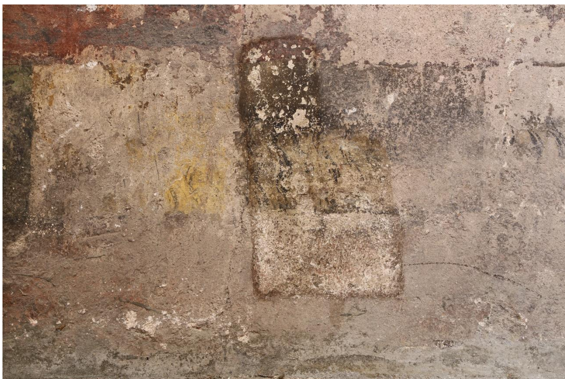
Obrázek 22: Rozšířená zkouška čištění v oblasti pod červenou šablonou, provedená toluenem, který byl aplikován čistícím štětcem.
