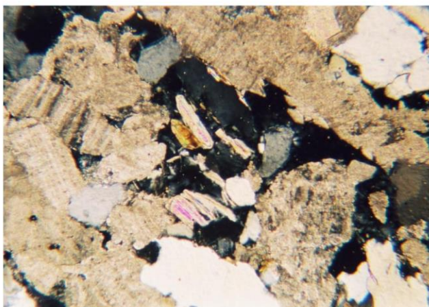
Vápenec biotritický, mikrit-sparitový (příbojová facie) vzorek BK-1, zadní strana, zvětšení 32x, nikoly X nevýrazná příměs slídy – muskovitu, v interklastickém prostoru
