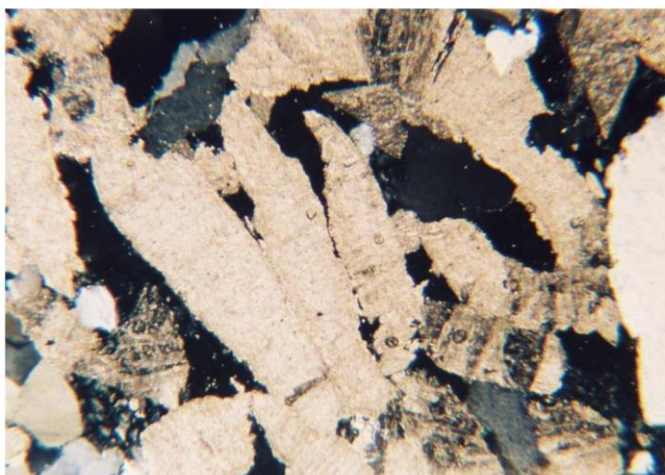
Vápenec biotritický, mikrit-sparitový (příbojová facie) vzorek BK-1, zadní strana, zvětšení 32x, nikoly X lokálně zvýšená porozita způsobená pozicí prizmatických vrstviček
