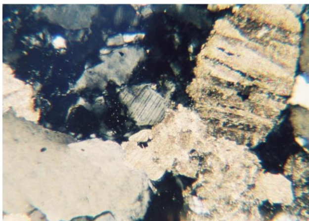
Vápenec biodetritický, mikrit-sparitový (příbojová facie) vzorek BK-1, zadní strana, zvětšení 63x, nikoly X přítomnost klastického živce (plagioklas) v základní hmotě
