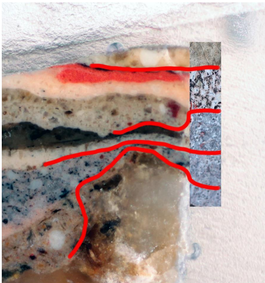
Obrázek 3 Komparace provedené sondy a snímku stratigrafie, autor fotografie stratigrafie vzorku: Petra Lesniaková
