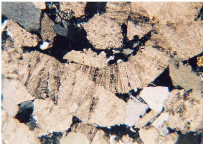
Vápenec biodetritický, mikrit-sparitový (příbojová facie) vzorek BK-1, zadní strana, zvětšení 32x, nikoly X, \varnothing fragmentu 0,26x0,24 mm struktura: fragmenty prizmatických vrstviček schránek měkkýšů
