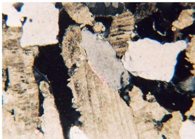
Vápenec biodetritický, mikrit-sparitový (příbojová facie) vzorek BK-1, zadní strana, zvětšení 32x, nikoly X, \varnothing Q 0,74x0,29 mm slída-muskovit součástí křemenného klastu (hornina), porozita (černá)
