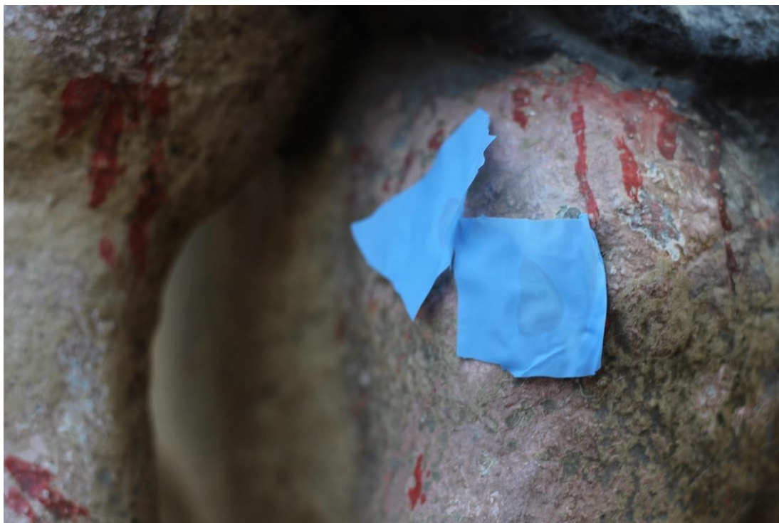
Obrázek 29 Restaurátorský průzkum – zkoušky snímání – aplikace organických rozpouštědel v gelu
