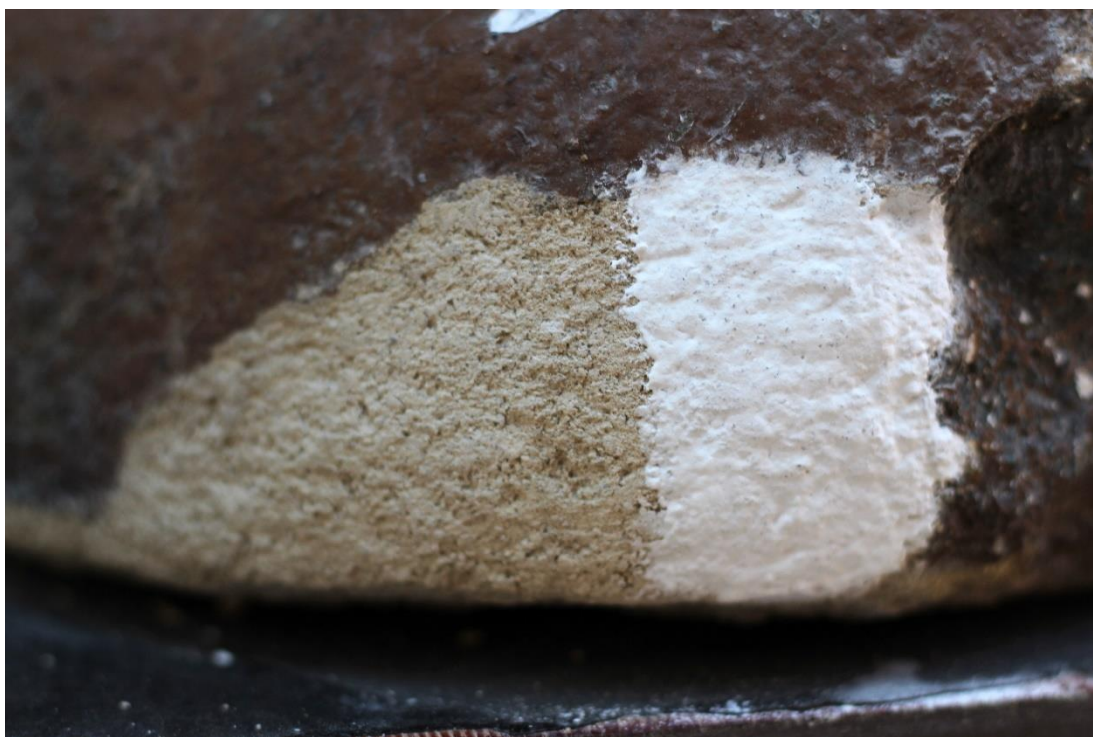
Obrázek 55 Zkouška finální úpravy plastické retuše pomocí akrylátového tmelu
