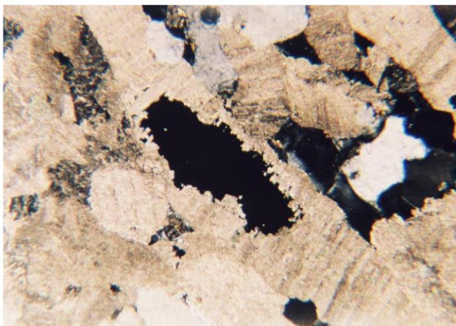
Vápenec biodetritický, mikrit-sparitový (příbojová facie) vzorek BK-1, zadní strana, zvětšení 32x, nikoly X, ø koroz. otvoru 0,77x0,26 mm korozí prizmatické vrstvičky, porozita (černá)
