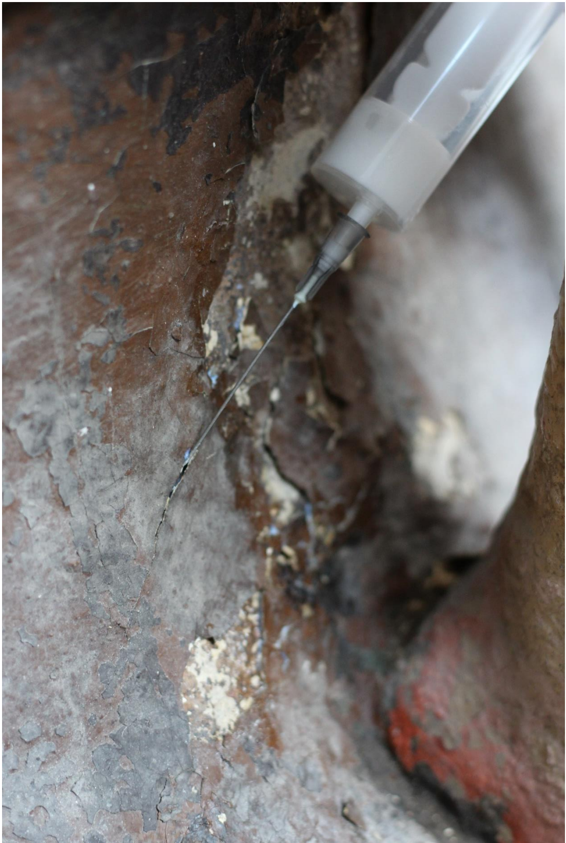
Obrázek 32 Průběh restaurování – aplikace akrylátové disperze Ackrylkleber 498 HV pod odlupující se povrchovou úpravu
