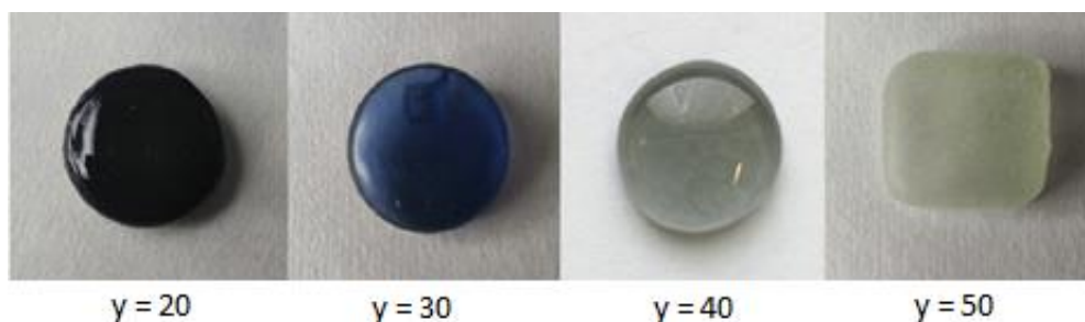
Obr. 19 Vzhled vzorků skel řady B: yK_2O-20WO_3-(80-y)P_2O_5 . Vzorky jsou seřazeny od 20-50 mol.% K_2O .
