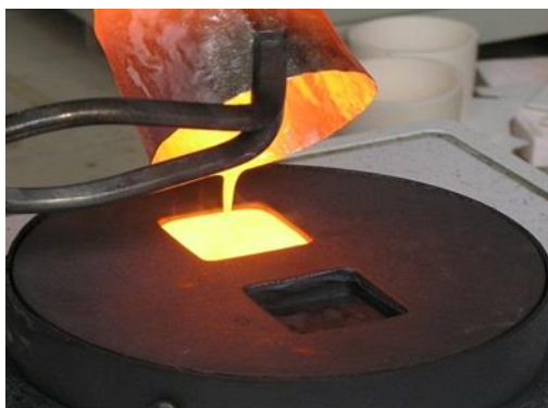
Obr. 13 Odlévání fosfátových skel do grafitových forem.
