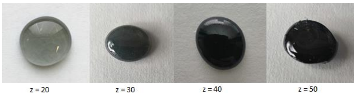
Obr. 20 Vzhled vzorků skel řady C: (50-1/2z)K_2O-zWO_3-(50-1/2z)P_2O_5 . Vzorky jsou seřazeny od 20-50 mol.% WO_3 .
