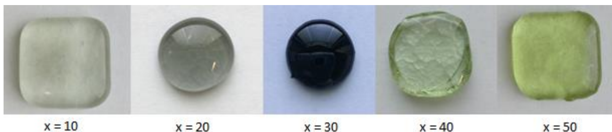
Obr. 18 Vzhled vzorků skel řady A: 40K_2O-xWO_3-(60-x)P_2O_5 . Vzorky jsou seřazeny od 10-50 mol.% WO_3 .
