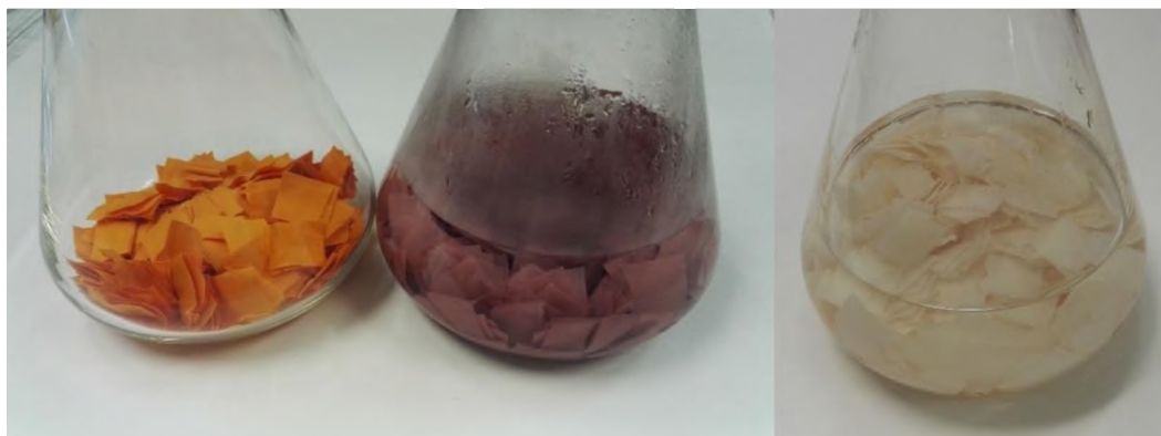
Obrázek 30: Změna zbarvení textilu obarveného barvivem č. 1 vlivem redukce
