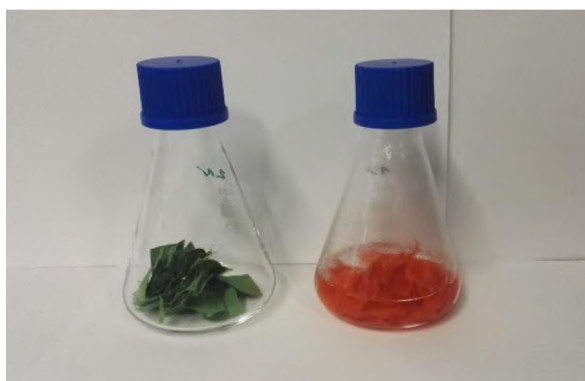
Obrázek 31: Bavlněná tkanina obarvená barvivem č. 3 před redukcí a po redukcí normou ČSN EN ISO 14362-1
