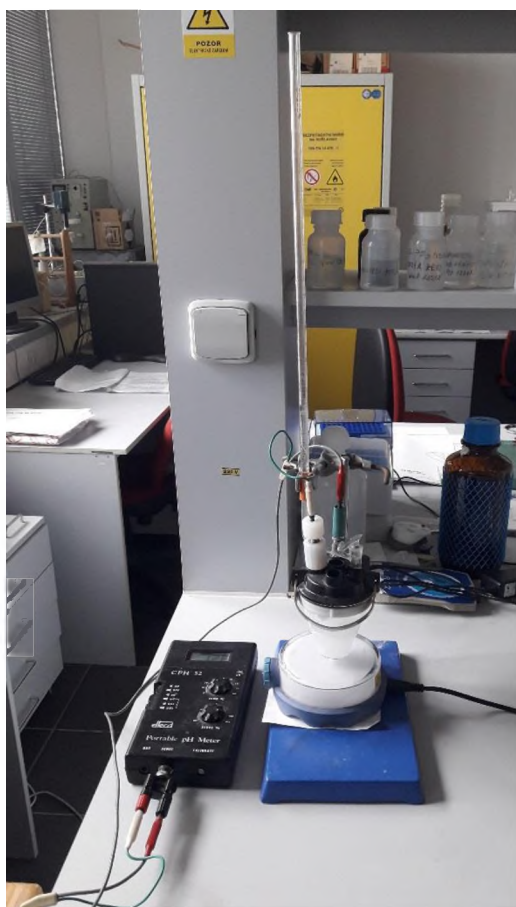
Obrázek 30: Titrační sestavy: vlevo – manuální titrace, vpravo – automatická titrace
