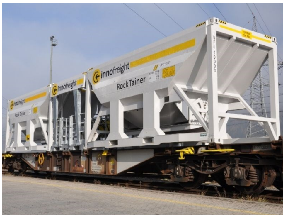
Obrázek 2 Rocktainer- vnitrozemský kontejner pro přepravu sypkých hmot 3
