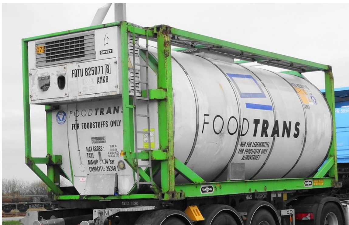
Obrázek 3 Vnitrozemský cisternový kontejner s doplněným agregátem 4
