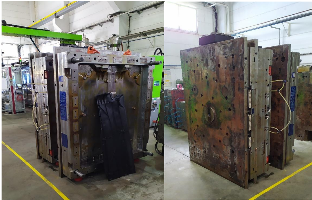
Obrázek 21: Vstřikovací forma s hmotností nad 10 tun
