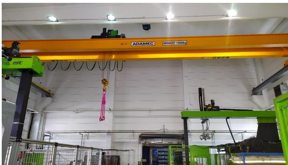
Obrázek 19: Mostový jeřáb s nosností 15 tun
