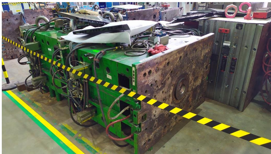
Obrázek 17: Forma střední velikosti do hmotnosti 10 tun
