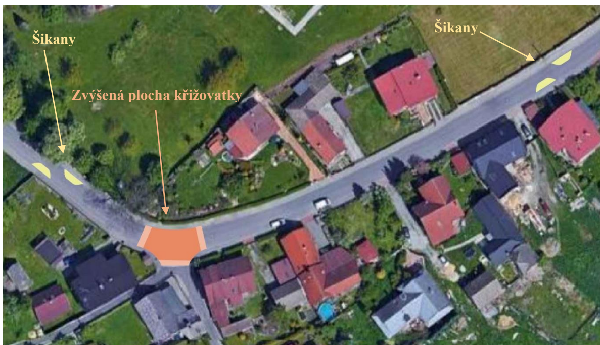
Obrázek 31 Zklidňující opatření v ulici Dlouhoveská
