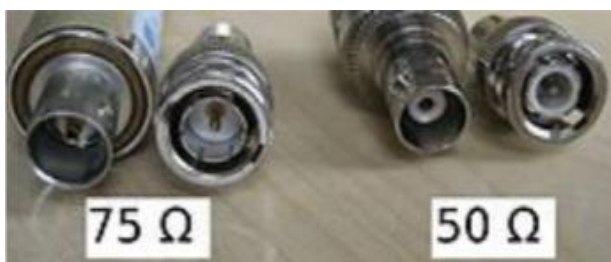
Obrázek 44 Rozdíl mezi 75 \Omega a 50 \Omega BNC konektory [43]
