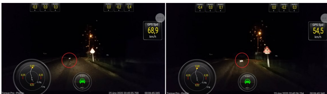
Obrázek 32: Kočka na vozovce – uvolnění brzdového pedálu
