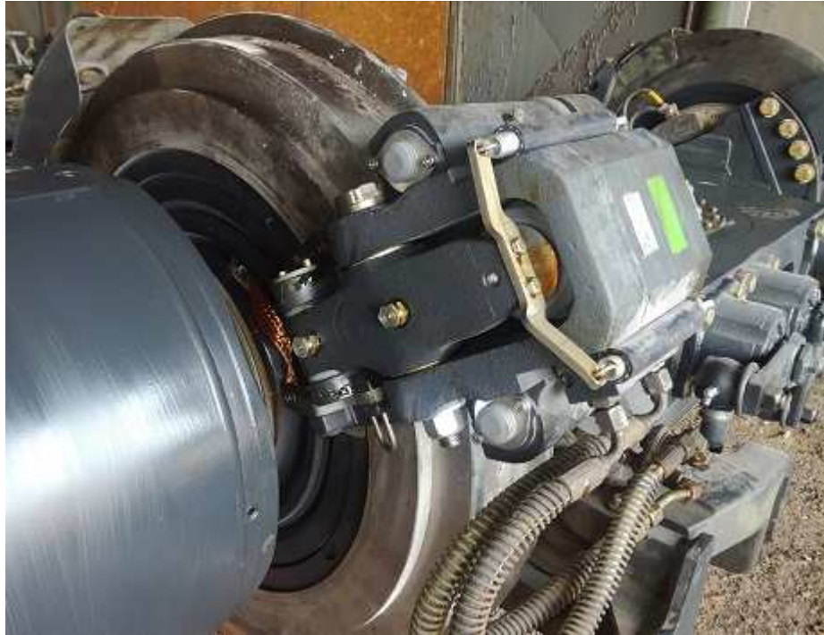
Obr. 32 Kotoučová brzda K.P.T 010 15T namontovaná na pojezdu
