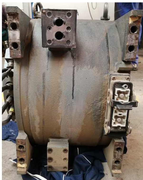
Obr. 51 Způsob uchycení motoru k podvozku
