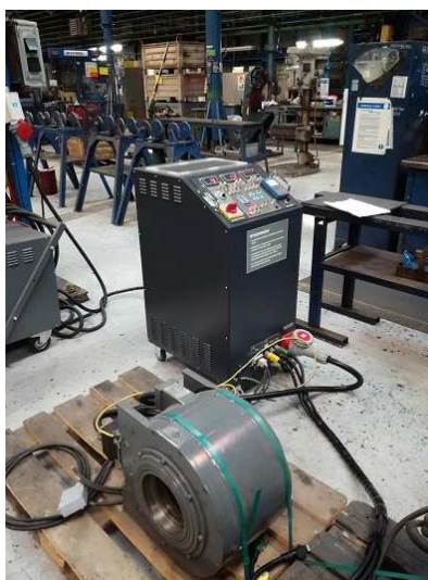
Obr. 34 Zdrojová a testovací jednotka TZDROJ 1415 připojena k trakčnímu motoru 4HLU 3436
