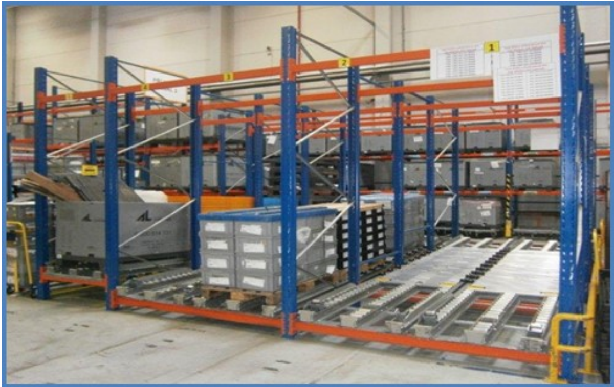
Obrázek 13 Válečkové spádové dráhy (Interní dokumentace, ©2019)
