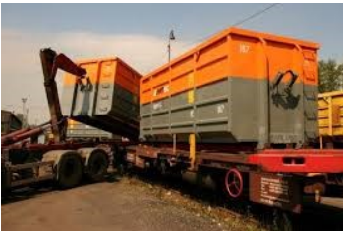
Obrázek 2 Horizontální technologie překládky (Univerzita Pardubice,2017)
