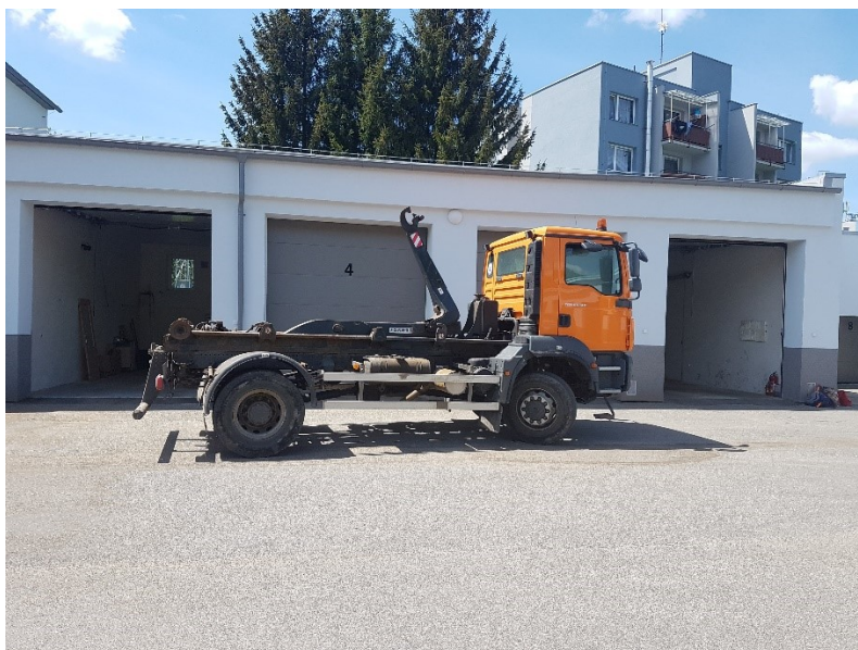
Obrázek 13 Vozidlo s hákovým nakladačem MAN
