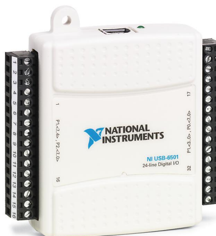
Obrázek 1.3 – Měřicí karta NI USB-6501 (National Instruments, 2020)
