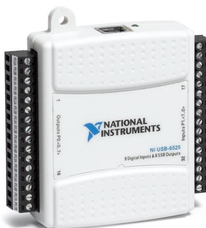
Obrázek 1.4 – Měřicí karta NI USB-6525 (National Instruments, 2020)
