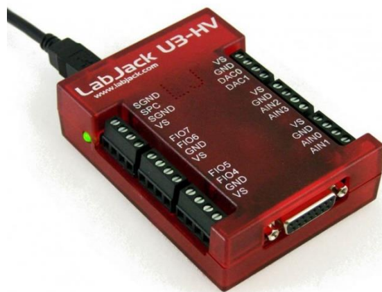
Obrázek 1.1 – Měřicí karta LabJack U3-HV (Michalec, 2019)
