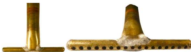
Obrázek 5 – Vstupní distributor se dvěma rameny (DD)
