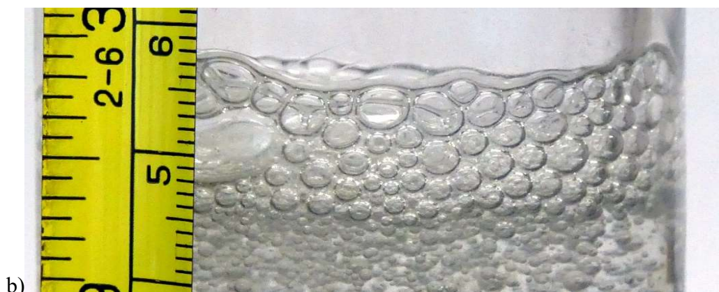
Obrázek 12 – Snímky pro počáteční výšku hladiny kapaliny a) a hladinu vrstvy při ukončení aerace b)
