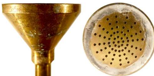
Obrázek 7 – Vstupní distributor ve tvaru sprchové hlavice (SD)
