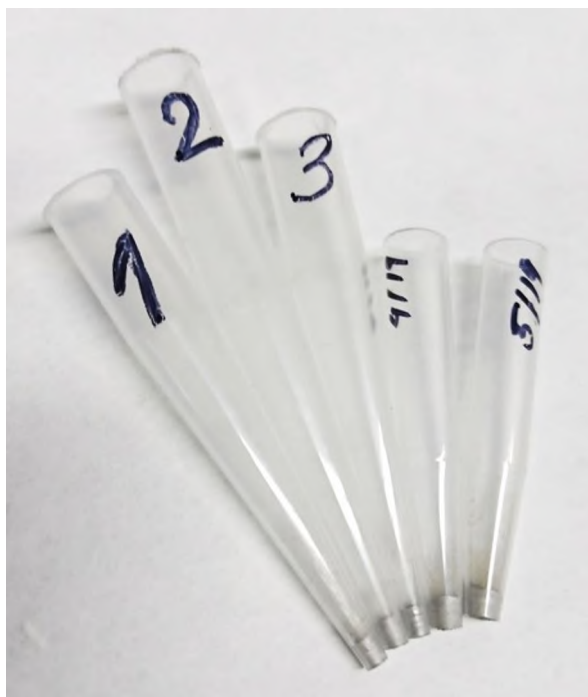
Obrázek 12 – Nově připravené ústí elektrod
