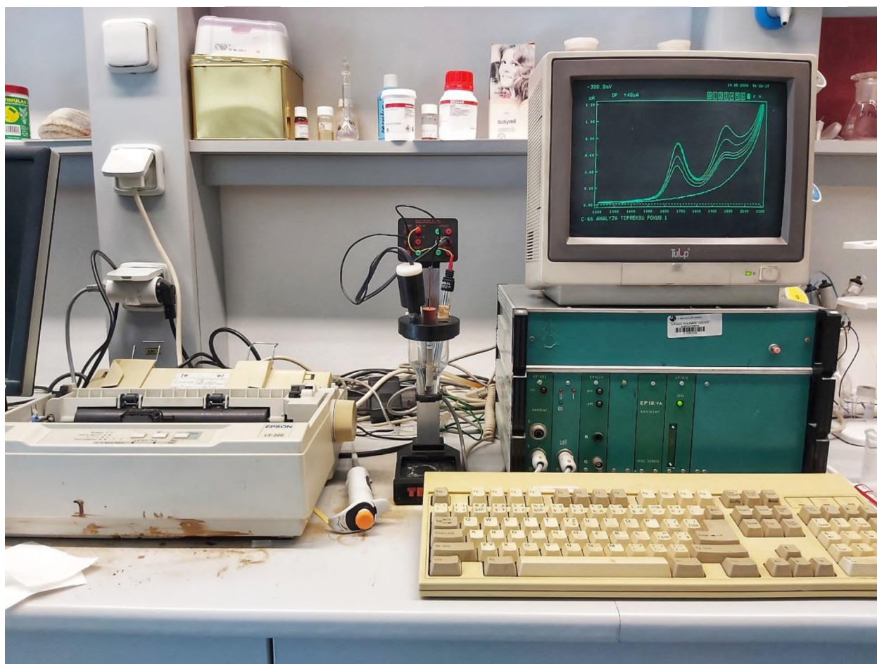
Obrázek 5: Elektrochemický analyzátor EP 100 propojený s tiskárnou a elektrochemickým článkem
