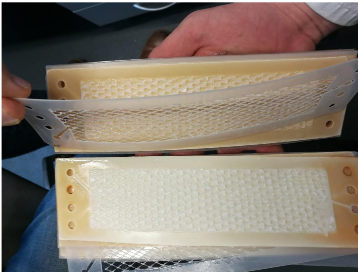
Příloha B - Experiment 7 - Vysrážený \text{CaSO}_4 na membráně (zobrazení 2)
