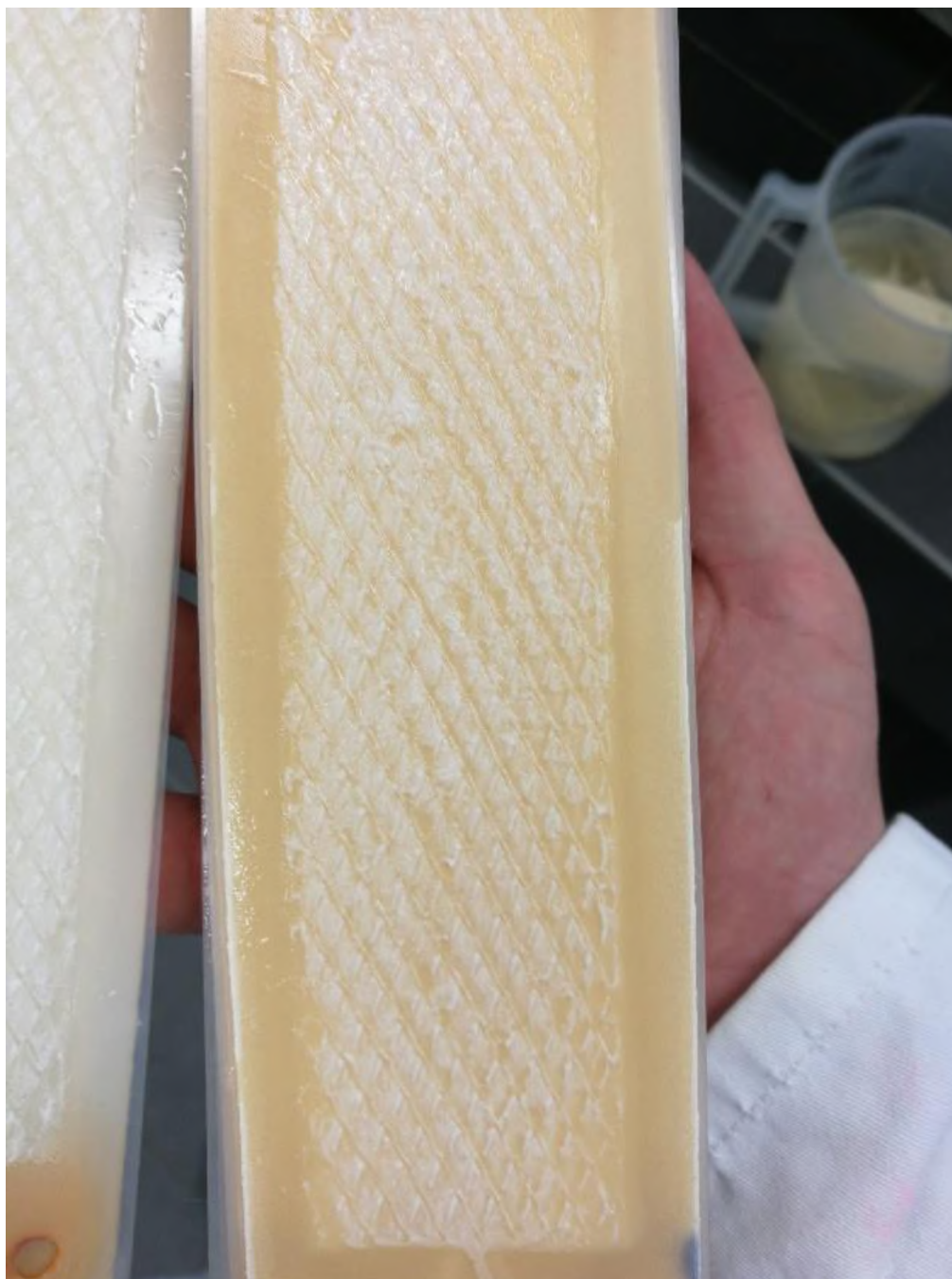
Příloha A - Experiment 7 - Vysrážený \text{CaSO}_4 na membráně (zobrazení 1)
