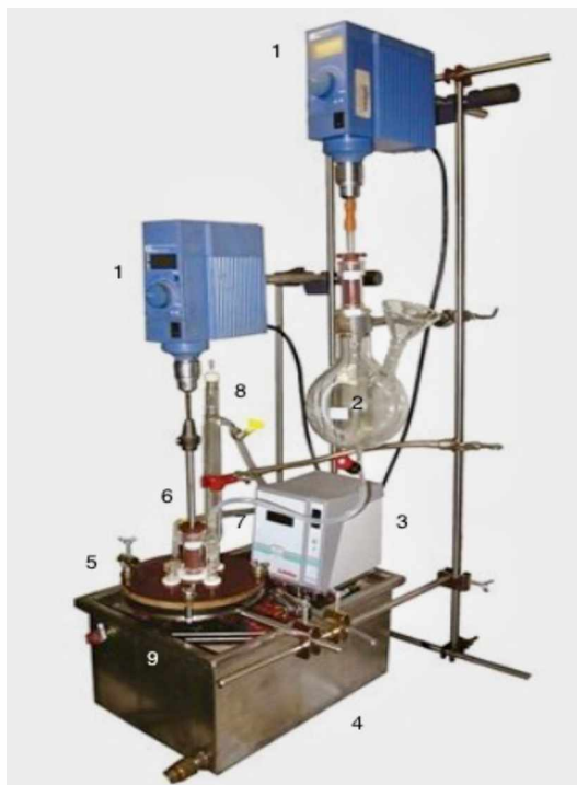
Obrázek 5 Aparatura k emulzní polymeraci, 1 – míchadlo, 2 – emulgační baňka, 3 – termostat, 4 – vodní lázeň s ohřívacím tělesem, 5 – těsnící kryt na polymerační reaktor, 6 – přívod inertního plynu, 7 – přívod monomerů, 8 – zpětný chladič, 9 – polymerační reaktor; převzato a upraveno z: [5]
