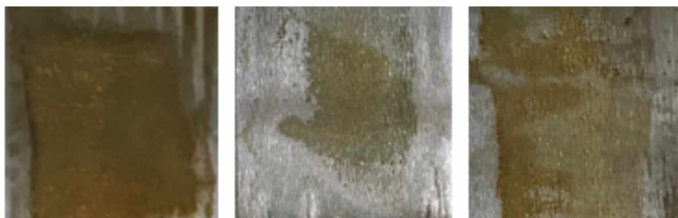
Obrázek 27 Odolnost nátěrových filmů vůči bleskové korozi: vlevo: L0, ve středu: LL, vpravo: LL+
