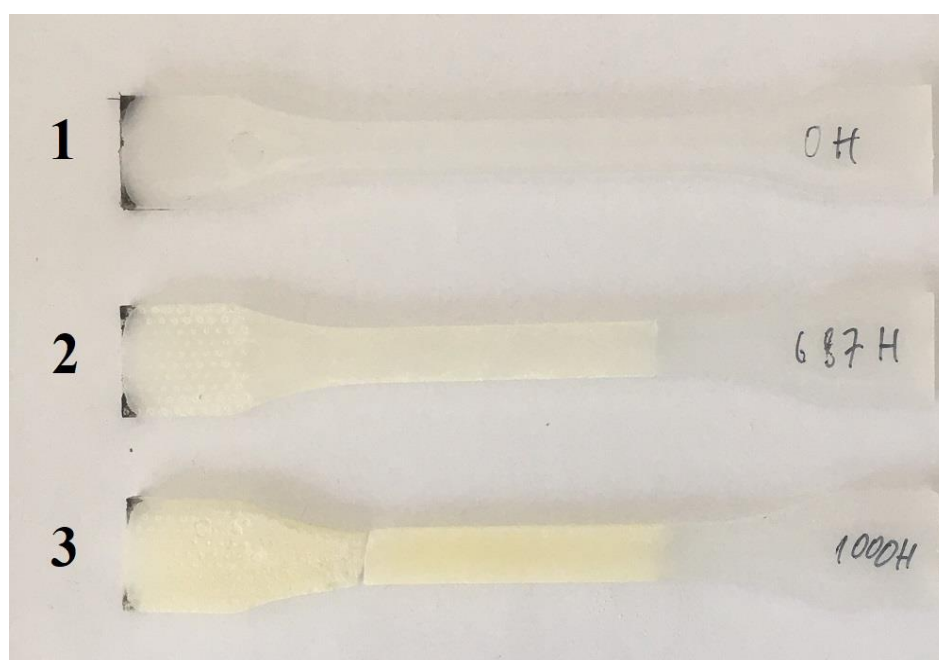
Obrázek 44 - Změna barvy nestabilizovaných vzorků PP vlivem doby expozice, kde: 1) Neexponován, 2) Exponován 687 h, 3) Exponován 1000 h
