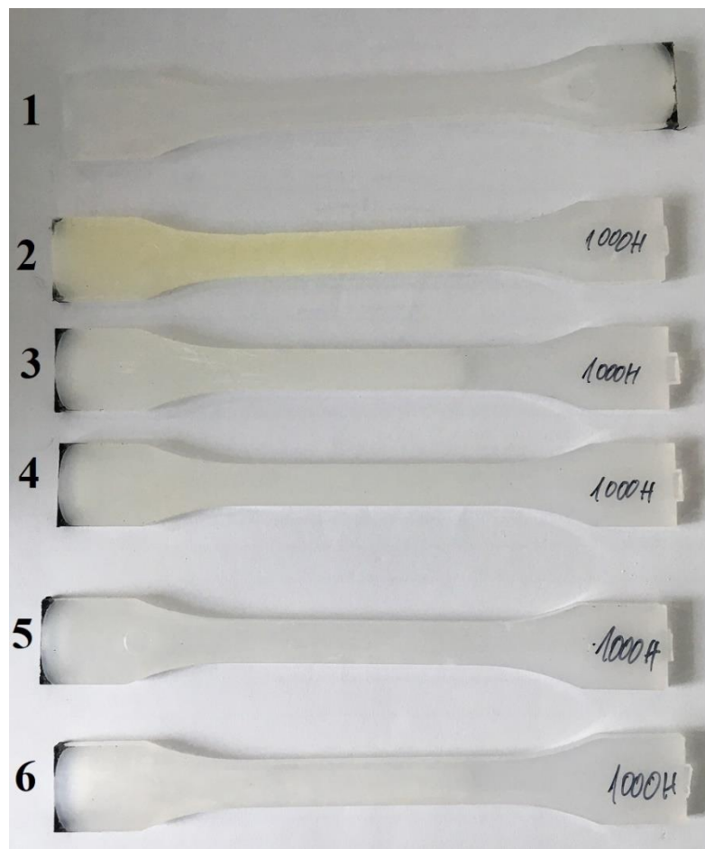
Obrázek 46 - Změny vzhledu PP po expozici kde: 1) Nestabilizovaný neexponovaný vzorek, 2) Nestabilizovaný exponovaný vzorek 1000 h, 3) Stabilizovaný 0,1 % Chimassorb exponován 1000 h, 4) Stabilizovaný 0,2 % Chimassorb exponován 1000 h, 5) Stabilizovaný 0,1 % Tinuvin exponován 1000 h, 6) Stabilizovaný 0,2 % Tinuvin exponován 1000 h
