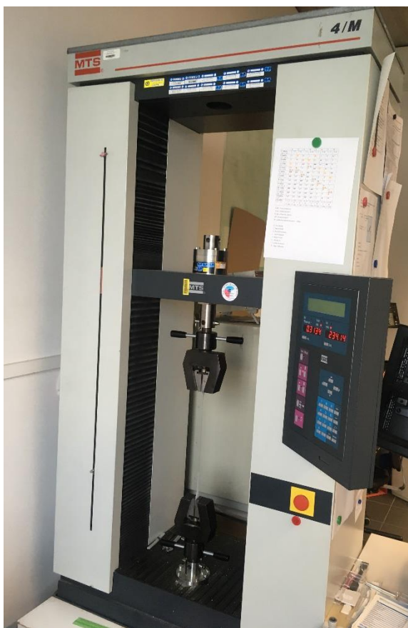
Obrázek 26 - Přístroj MTS-4/M pro měření zkoušek v tahu a v ohybu
