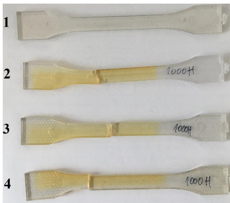
Obrázek 55 - Změny vzhledu PC po expozici kde: 1) Nestabilizovaný neexponovaný vzorek, 2) Nestabilizovaný exponovaný vzorek 1000 h, 3) Stabilizovaný 0,1 % Tinuvin exponován 1000 h, 4) Stabilizovaný 0,2 % Tinuvin exponován 1000 h
