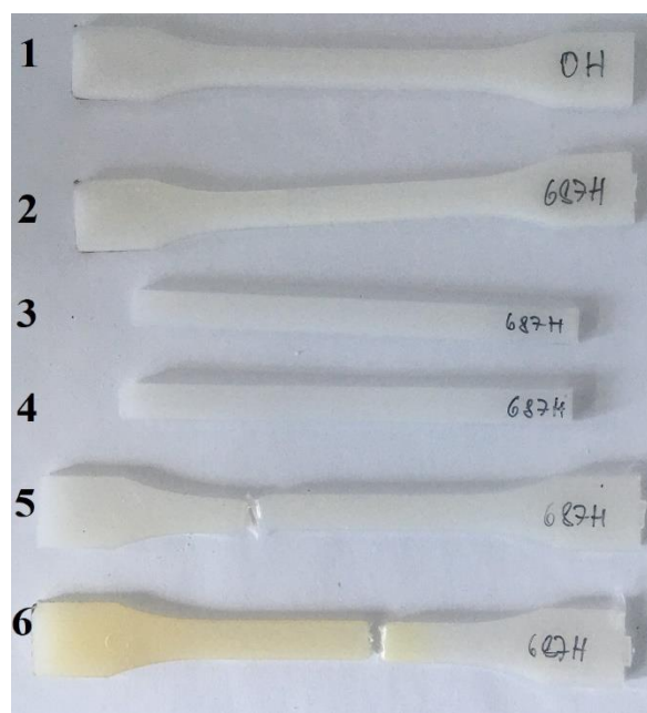
Obrázek 40 - Změny vzhledu LDPE po expozici kde: 1) Nestabilizovaný neexponovaný vzorek, 2) Nestabilizovaný exponovaný vzorek 687 h, 3) Stabilizovaný 0,1 % Tinuvin exponovaný 687 h, 4) Stabilizovaný 0,2 % Tinuvin exponovaný 687 h, 5) Stabilizovaný 0,1 % Chimassorb exponovaný 687 h, 6) Stabilizovaný 0,2 % Chimassorb exponovaný 687 h
