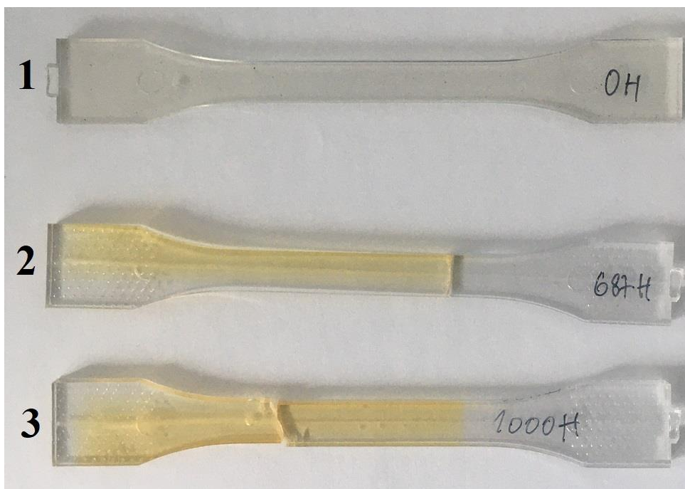
Obrázek 53 - Změna barvy nestabilizovaných vzorků PC vlivem doby expozice, kde: 1) Neexponován, 2) Exponován 687 h, 3) Exponován 1000 h
