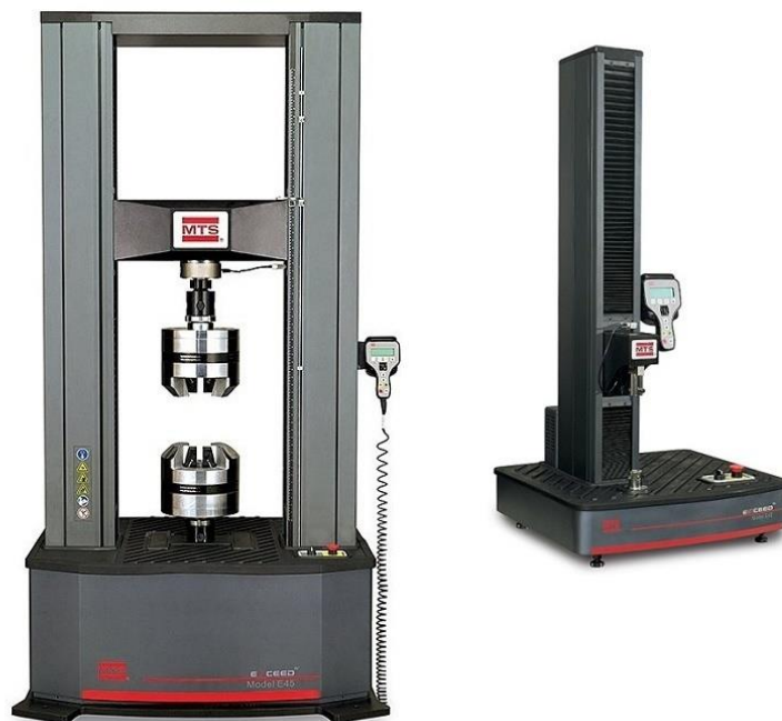
Obrázek 8 Trhací stroj MTS (45)
