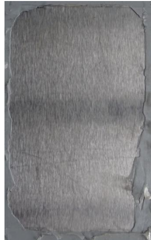
Epoxidový nátěr v kondenzaci
