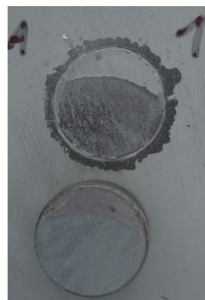
Povlak s vysokým obsahem zinku
