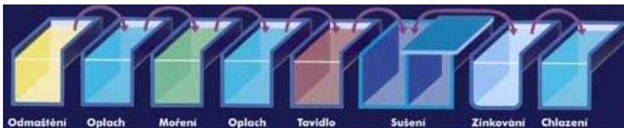
Obrázek 4: Schématické znázornění operací pro suchý proces zinkování (13)
