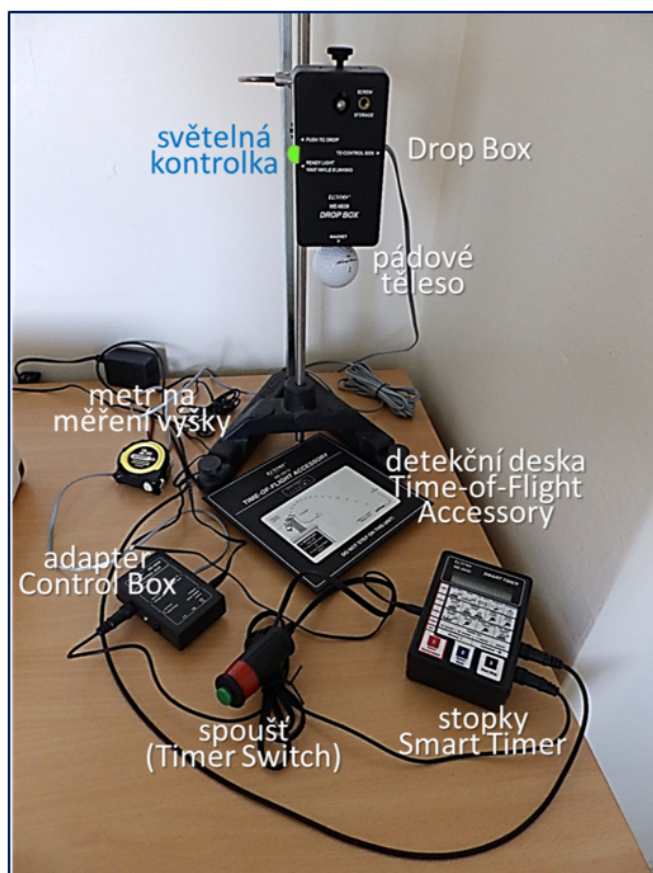
Obrázek 3.18: Experimentální sestava ke studiu volného pádu
