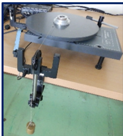
Obrázek 3.26: Pád závaží roztáčející kotouč
