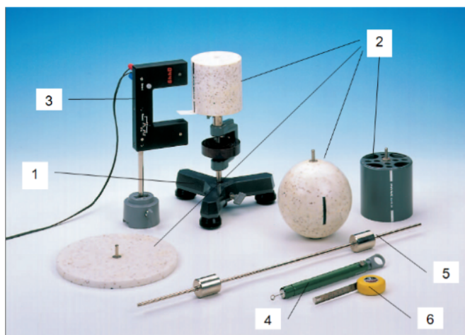
Obrázek 4.3: Sestava k úloze: 1 – stojan s pružinou a rotační osou s uchycením, 2 – různá tělesa (válec, koule, disk), 3 – světelná závora s čítačem, 4 – siloměr, 5 – tyč s posuvnými závažími, 6 – pravítko.
