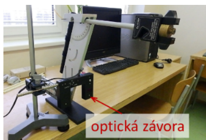
Obrázek 5.11: Umístění optické závory u výstupu hlavně balistického kyvadla
