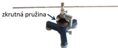
Obrázek 4.1: Stojan se spirálovou zkrutnou pružinou
