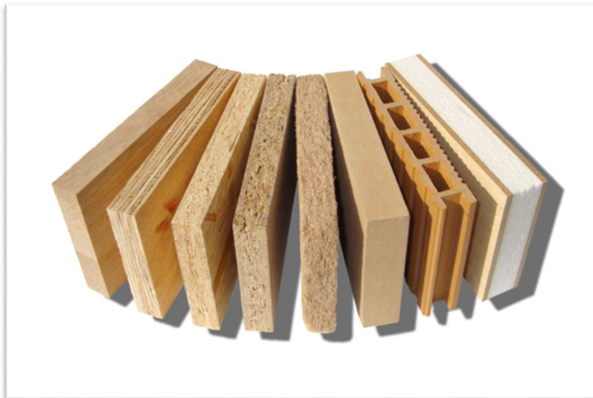
Obrázek 12: Materiály na bázi dřeva: Zleva: spárovka, překližka, deska z orientovaných plochých třísek (OSB), dřevotřísková deska, izolační (měkká) vláknitá deska, vláknitá deska se střední hustotou (MDF), dřevo-plastová deska (WPC), sendvičový panel.
