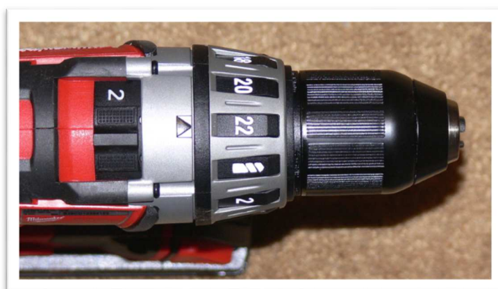
Obrázek 13: Akumulátorová vrtačka, nastavení utahovacího momentu
