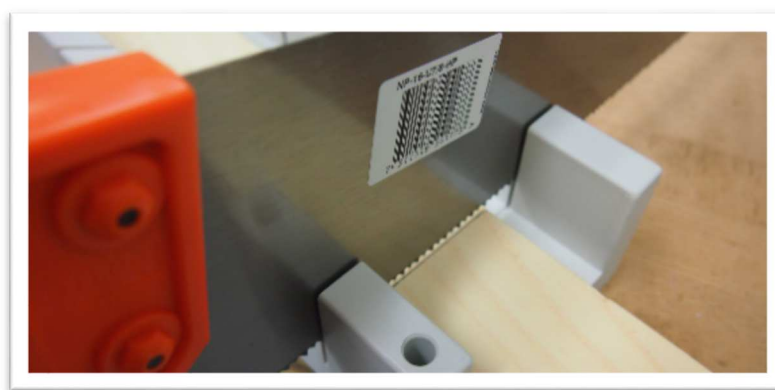
Obrázek 35: Pila ocaska a materiál v pokosnici
