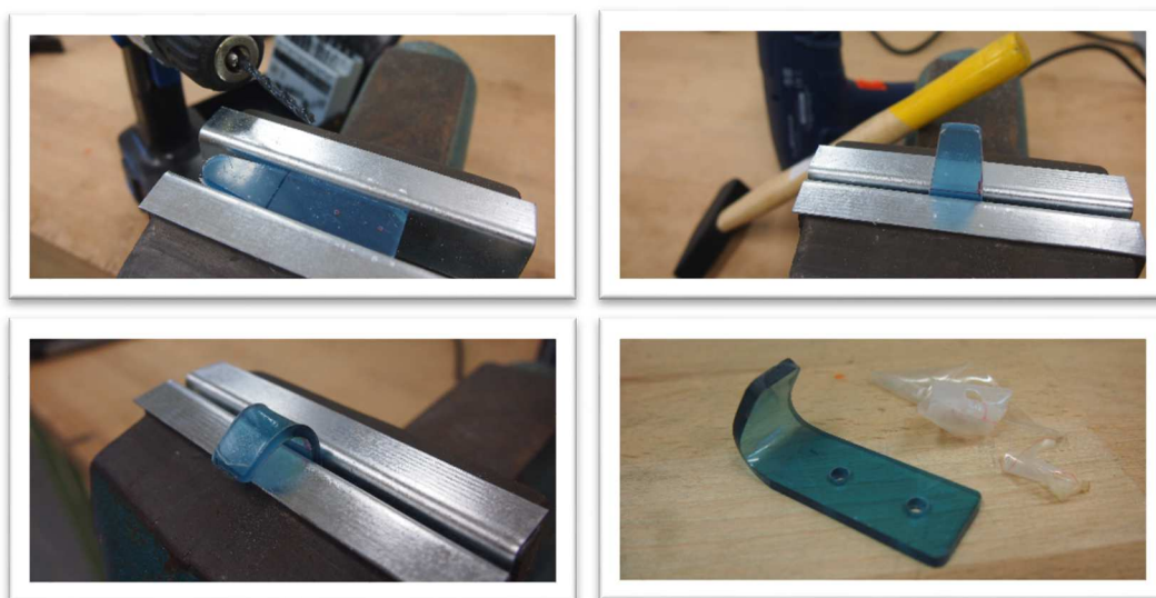
Obrázek 37: Vrtání a ohýbání háčku, hotový háček
