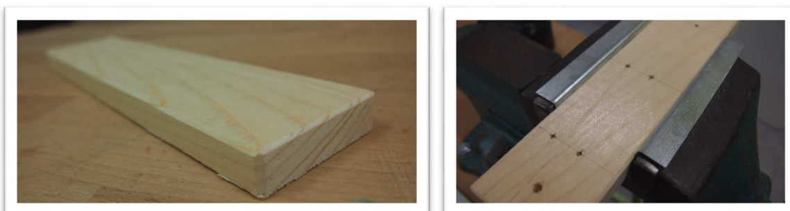
Obrázek 38: Ohraněná deska, odvrтанé otvory pro háčky na desce
