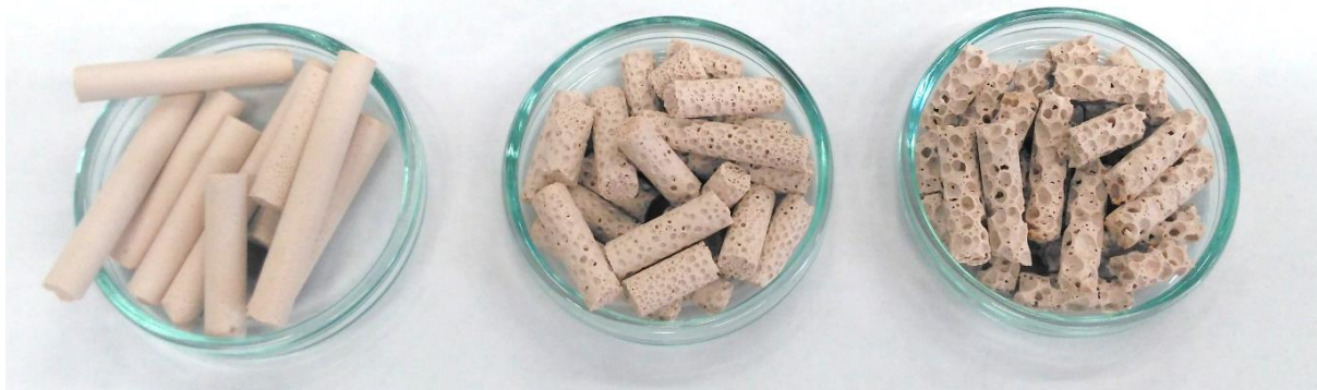
Obr. 7 Pelety geopolymerních pěn s kruhovým průřezem (průměr 5 mm)
