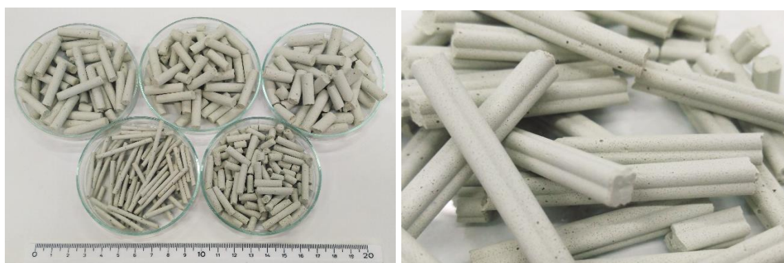
Obr. 6 Pelety zeolitových pěn s kruhovým průřezem (průměr 3 až 8 mm)(vlevo) a průřezem ve tvaru „tetralobu“ (průměr 5 mm)(vpravo)
