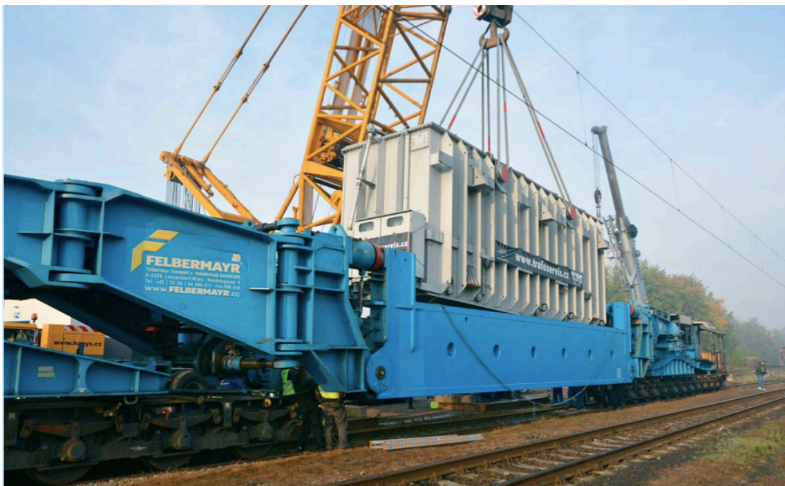
Obrázek 1 – Transformátor o hmotnosti 210 tun na 24nápravovém hlubinném vozem.
