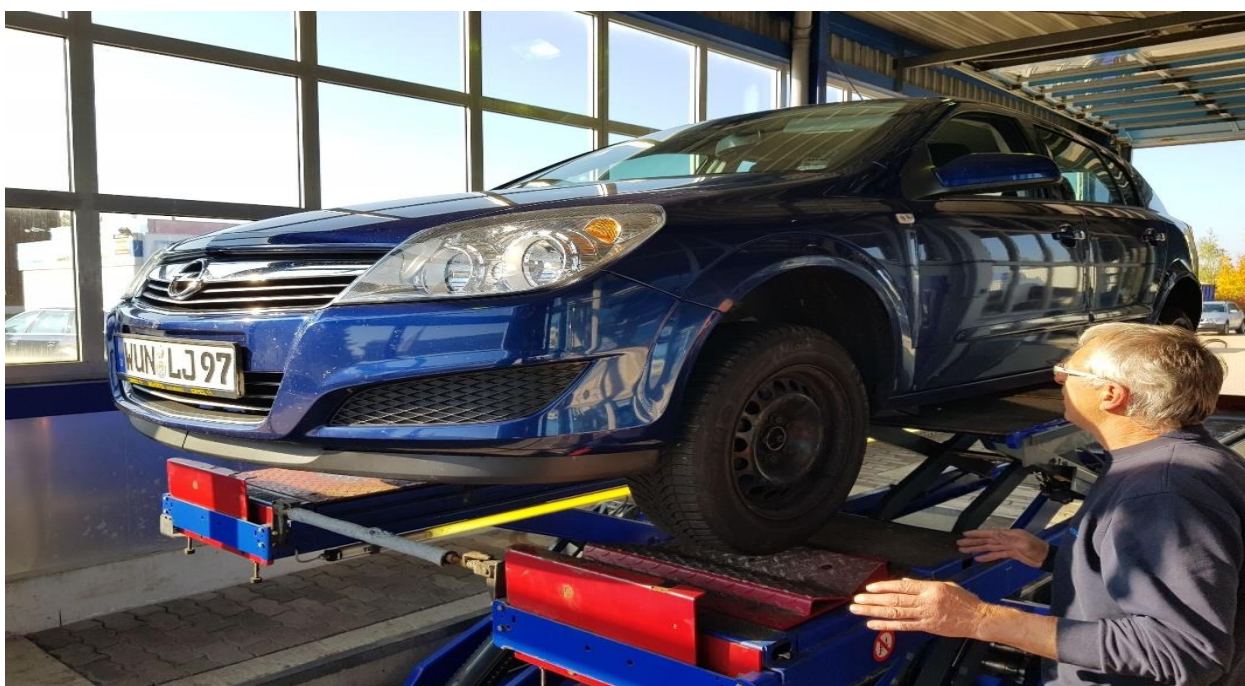
Obrázek 51 – Kontrola uložení tlumičů a stavu na stanovišti č. 3
