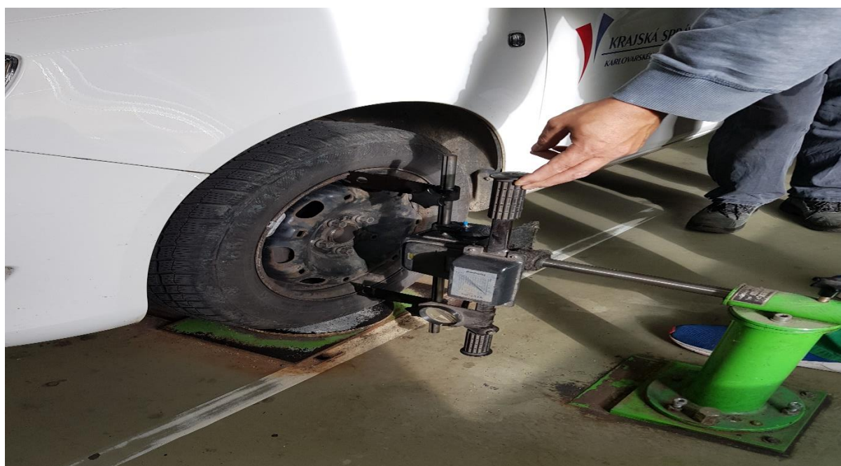
Obrázek 25 – Detail zařízení pro kontrolu sbíhavosti a odklonu kol přední nápravy
