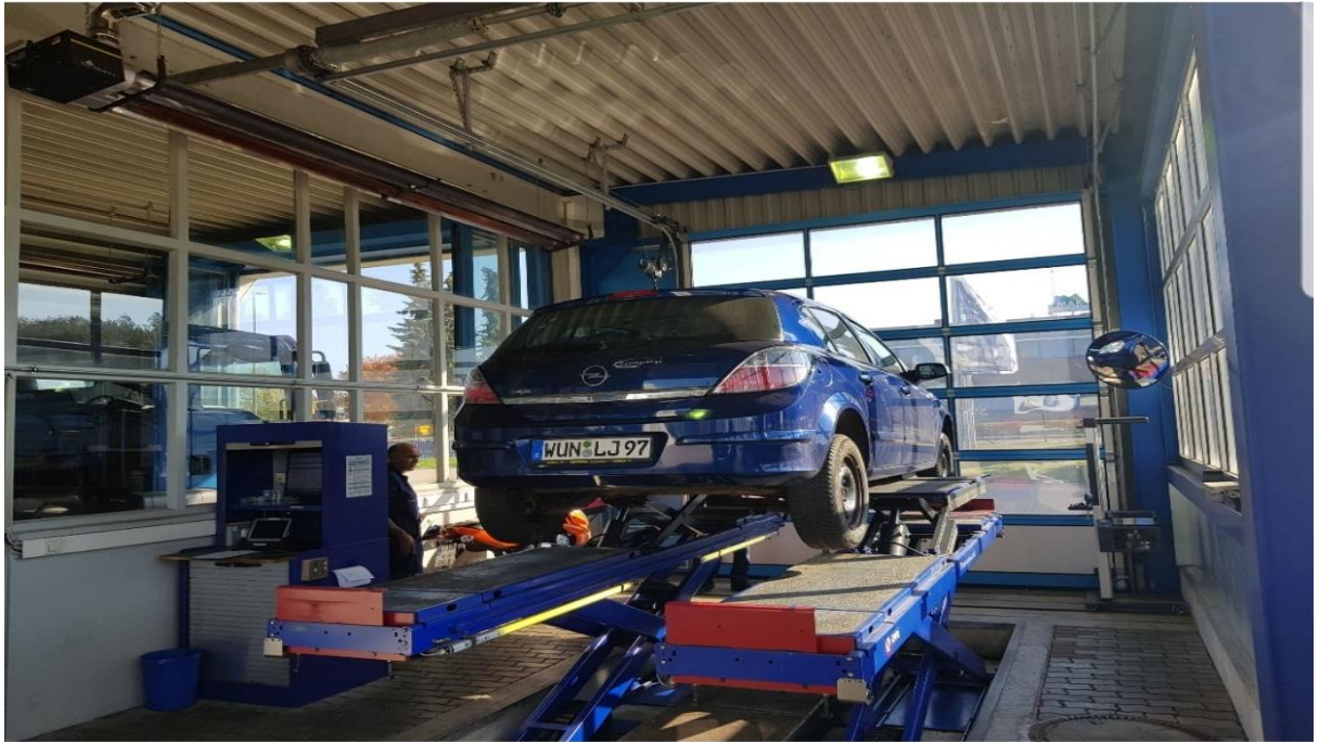
Obrázek 52 – Kontrola vůle ložisek kol a brzdového systému na stanovišti č. 3
