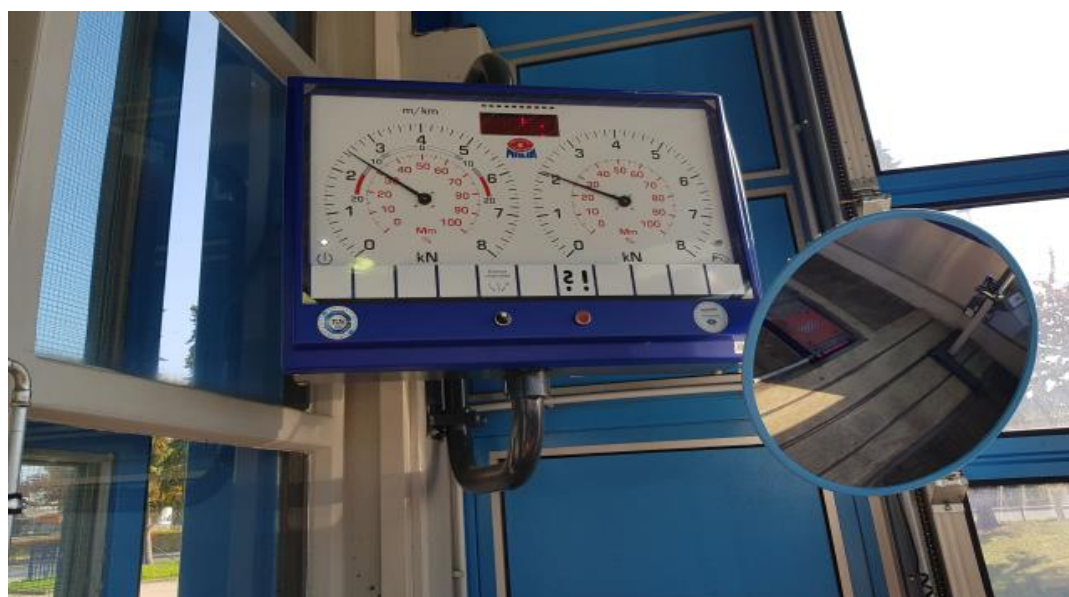
Obrázek 48 – Měřící a zobrazovací zařízení pro měření brzdového účinku
