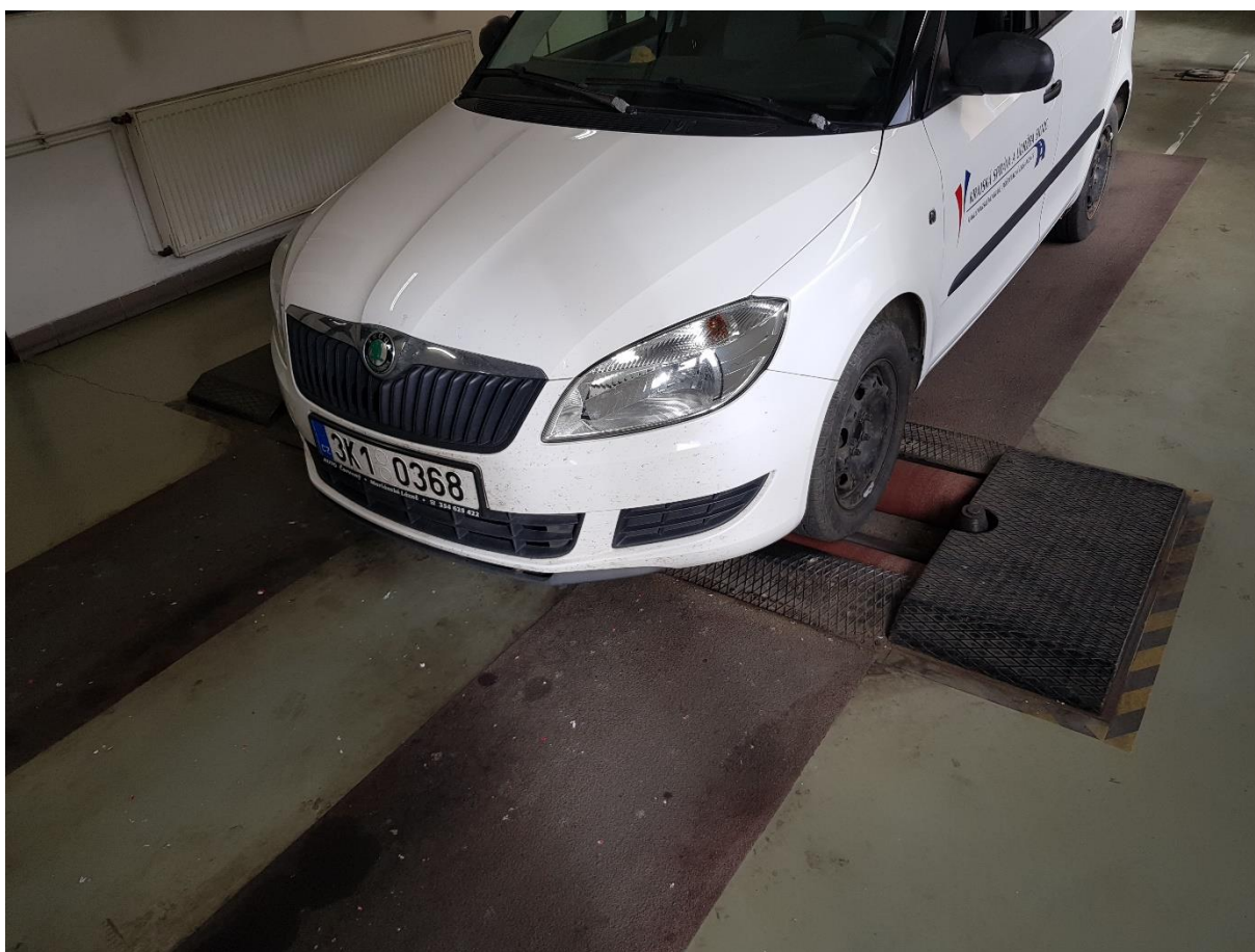
Obrázek 26 – Kontrolní stanoviště č. 3, válcová zkušebna brzd
