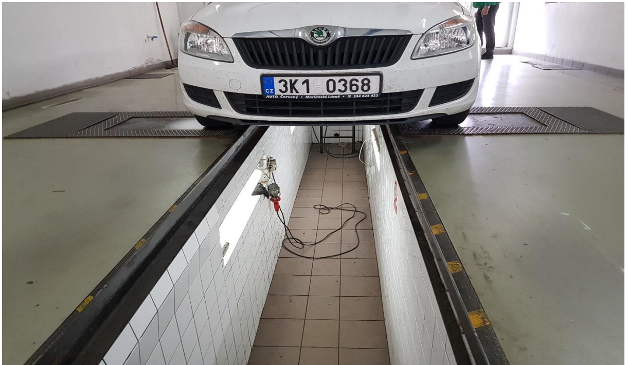
Obrázek 23 – Stanoviště č. 1, pracovní jáma pro kontrolu podvozku s hydropneumatickým zvedákem
