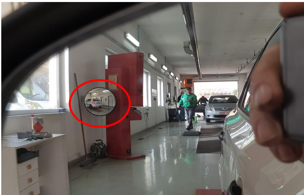
Obrázek 35 – Zrcadlo pro kontrolu zadních světlometů
