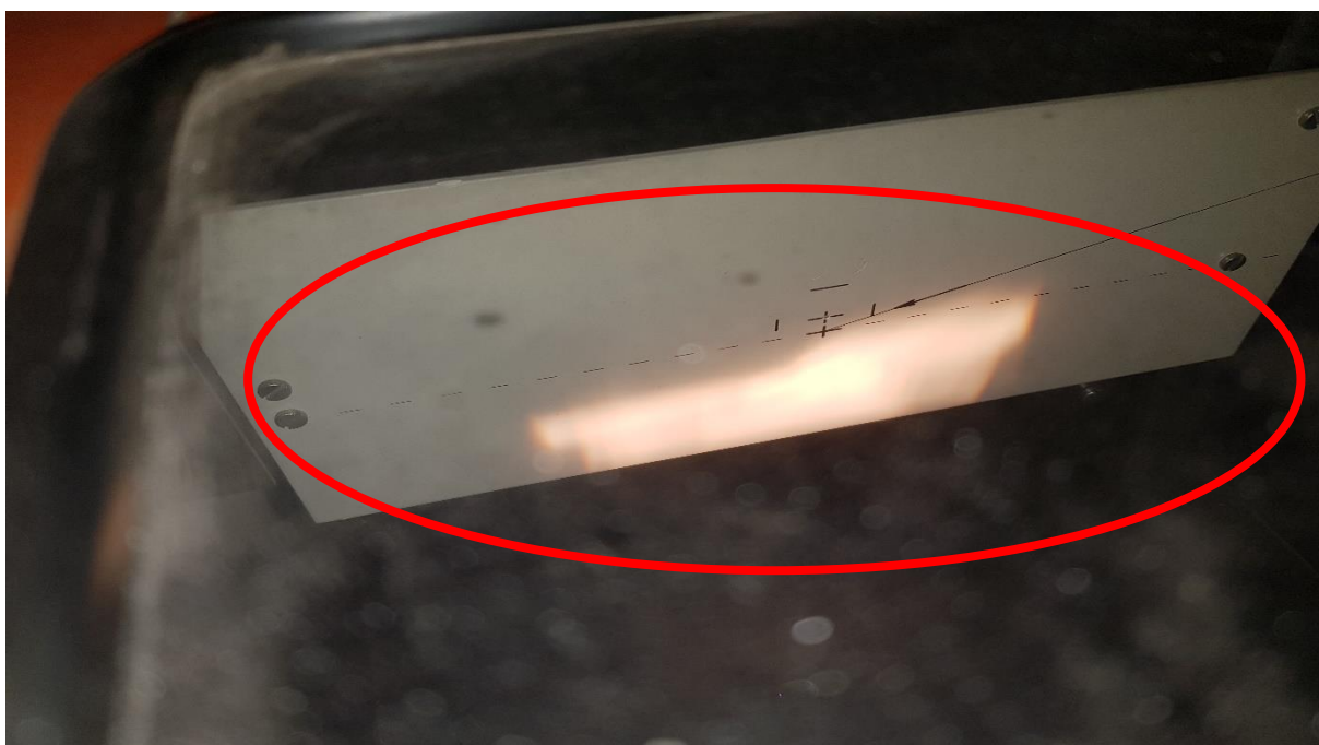
Obrázek 34 – Nesprávné nastavení světlometů
