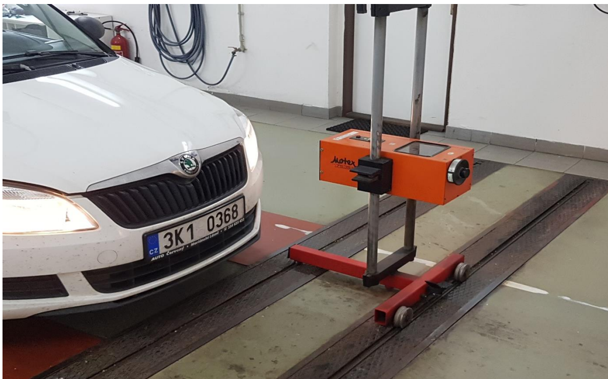
Obrázek 33 – Stanoviště č. 4 regloskop pro kontrolu základního nastavení světel
