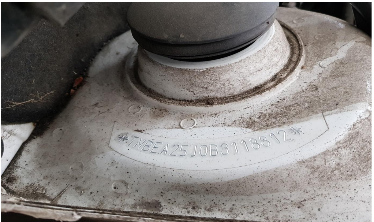
Obrázek 21 – Vyražené výrobní číslo na části karoserie (VIN)
