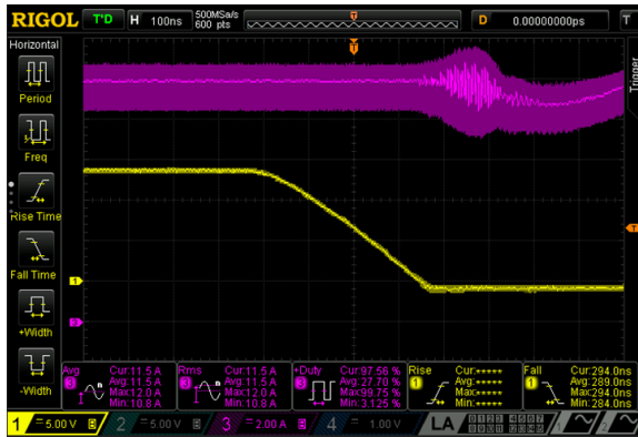
Obrázek 27: Sestupná hrana na gate N-MOSFETu při 100 mA činí 290 ns
