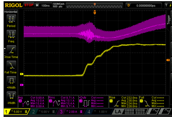
Obrázek 28: Vzestupná hrana na gate N-MOSFETu při 100 mA činí 230 ns
