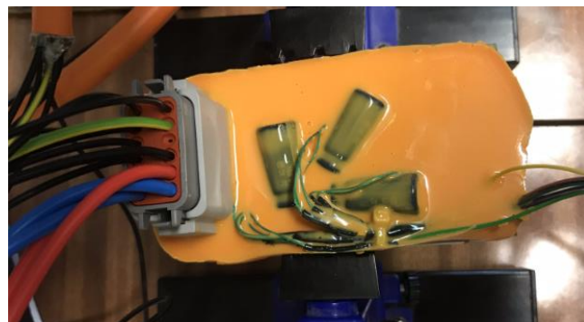
Obrázek 64: Finální provedení první fáze zalití
