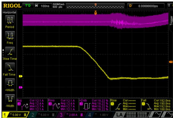
Obrázek 29: Sestupná hrana na gate N-MOSFETu při 150 mA činí 190 ns
