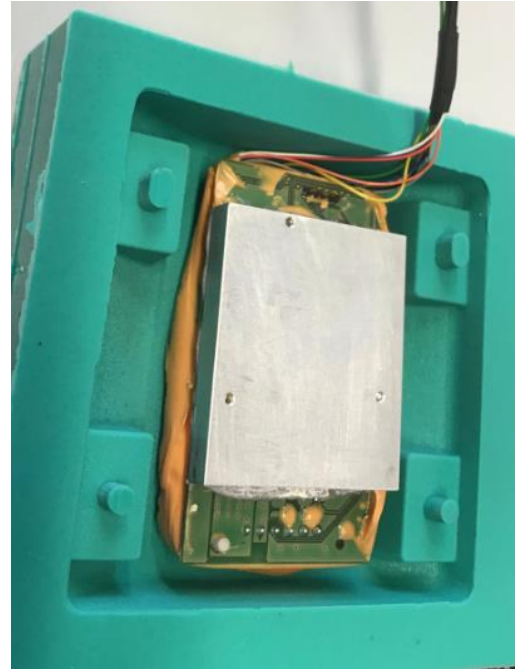
Obrázek 47: Vložení DPS do formy pro finální zalití
