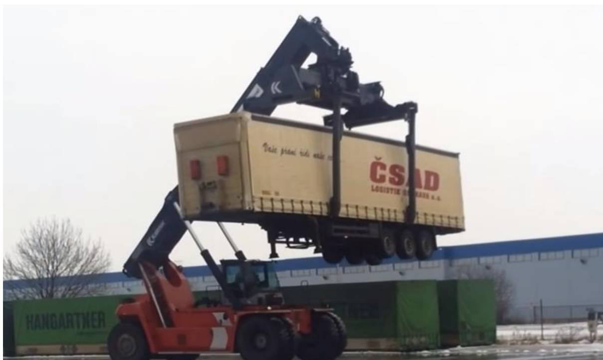
Obrázek 12 Manipulace reachstackeru se sedlovým návěsem (autor, 2013)
