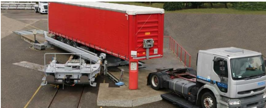
Obrázek 8 Překládka návěsu běžné stavby z železničního vozu na silniční tahač (Lohr Railway System, 2020)
