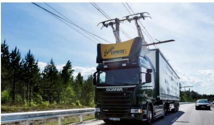
Obrázek 14 Nákladní automobil napájený elektrickou trakcí (Interesting Engineering, 2016)
