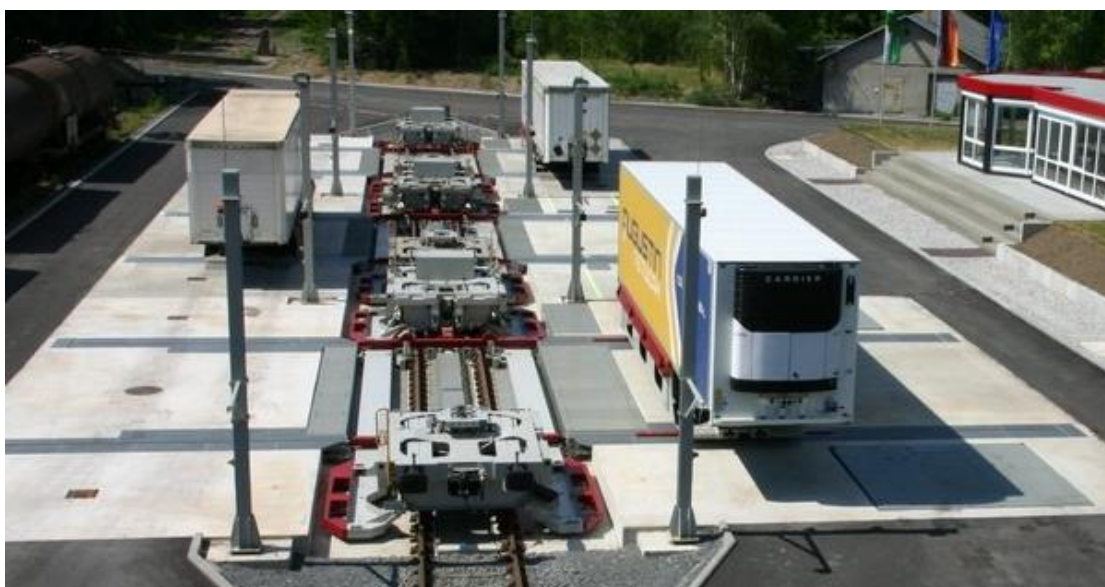
Obrázek 10 Překladiště vozů CargoBeamer (CargoBeamer, 2019)
