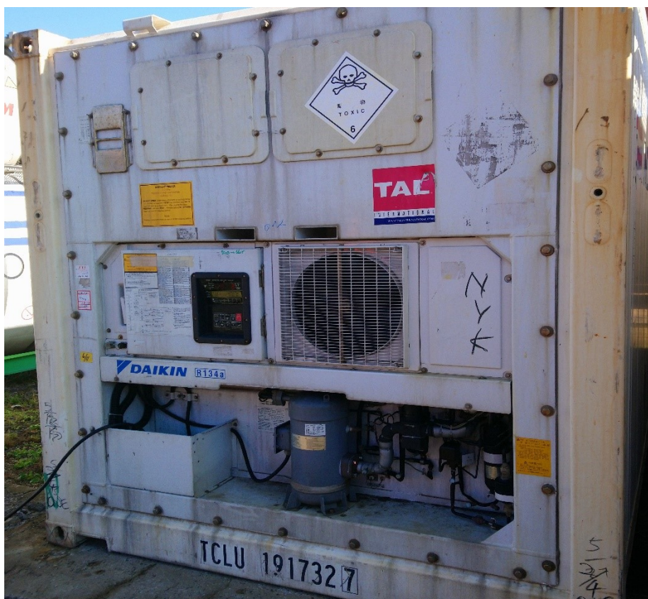
Obrázek 15 Chladicí jednotka chladírenského kontejneru (autor)
