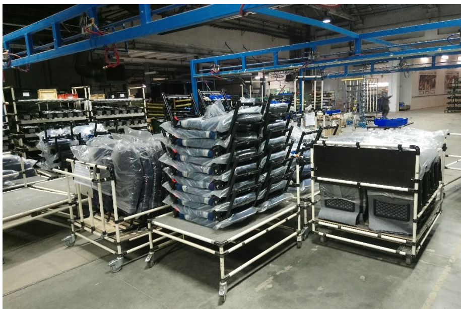
Obrázek 7 Krátkodobé skladování opracovaných opěr (Autor)
