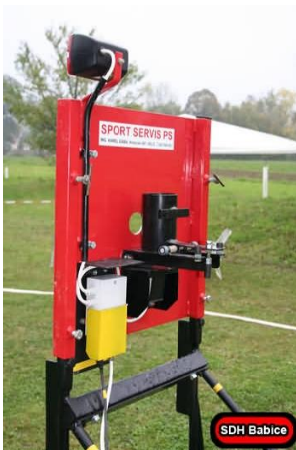
Obrázek 10 – Detail mechanismu sklopného terče [39]
