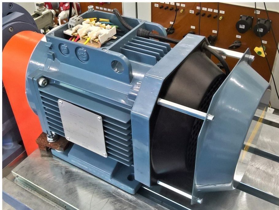
Obrázek 7 – SynRM ABB M3AL 100 LB 4 pro pracoviště KEEZ
