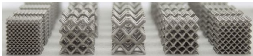
Obr. 11 –Příklady možných vnitřních struktur [18]
