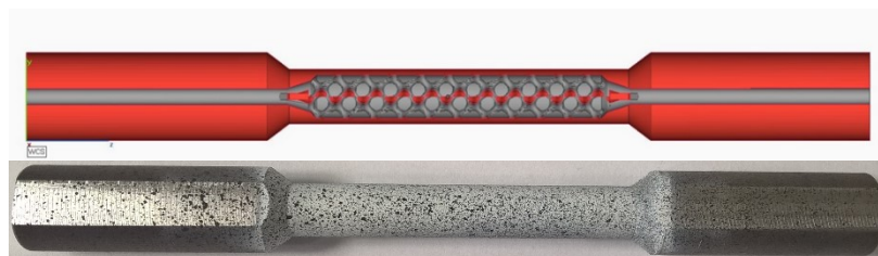
Obr. 19 – Vnitřní uspořádání gyroidu a reálný vzorek před zkouškou [33]
