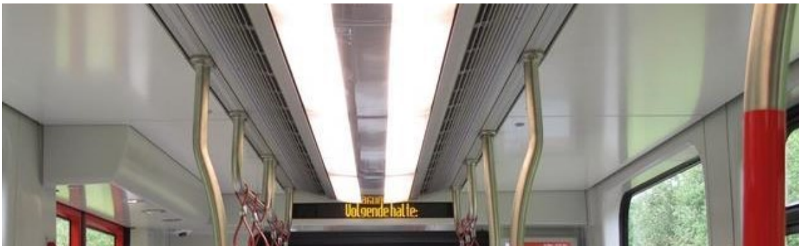
Obr. 8: Příklad osvětlení interiéru tramvaje (Siemens Avenio) [20]
