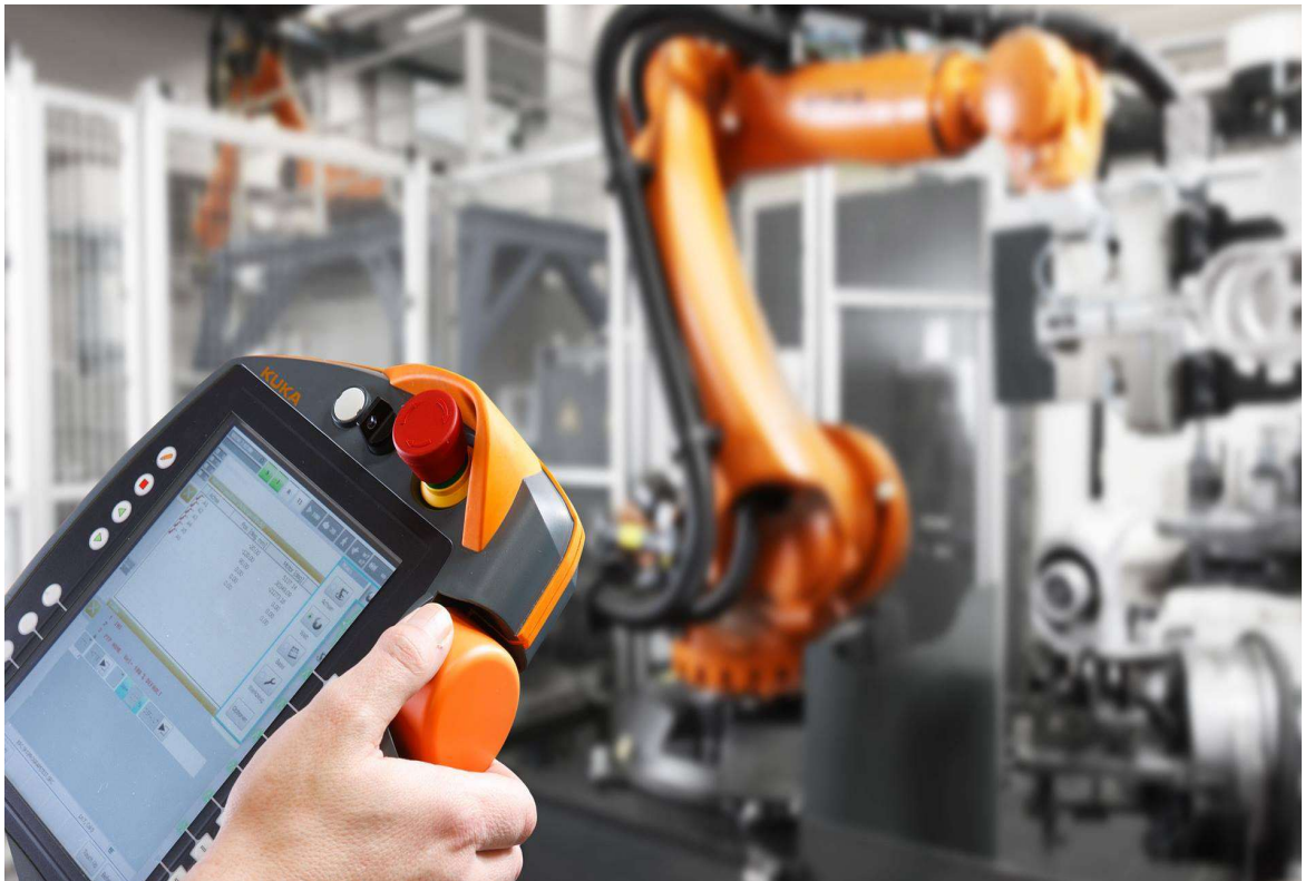
Obrázek 1.7 – Online programování pomocí teach pendantu (KUKA.SystemSoftware, 2019)
