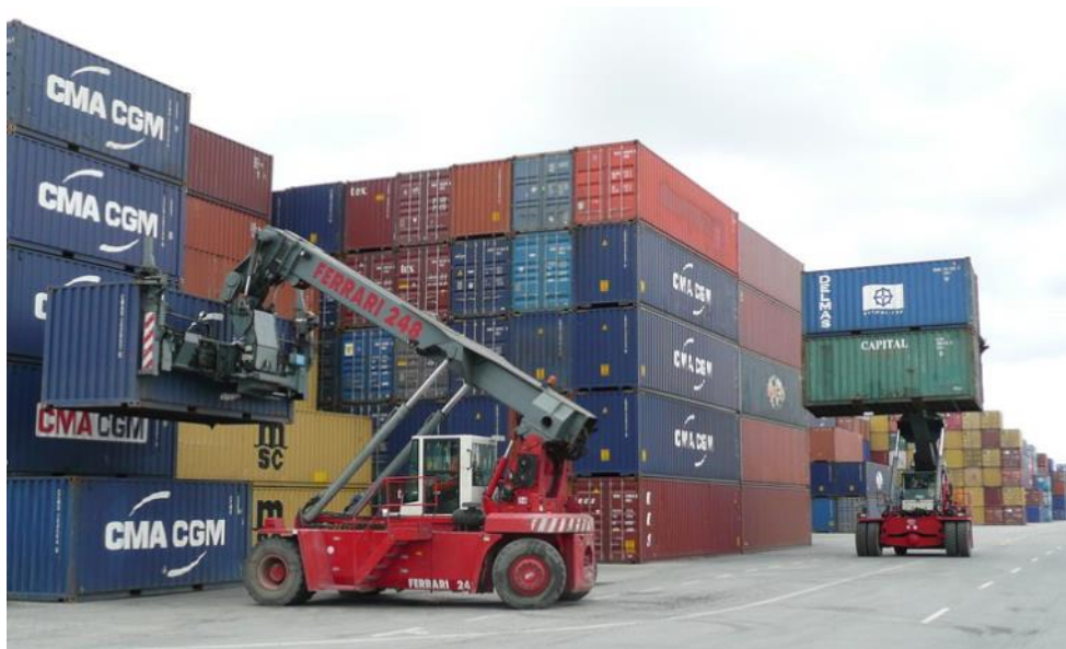
Obrázek 11 Manipulace pomocí spraeederů terminál Metrans Uhříněves
