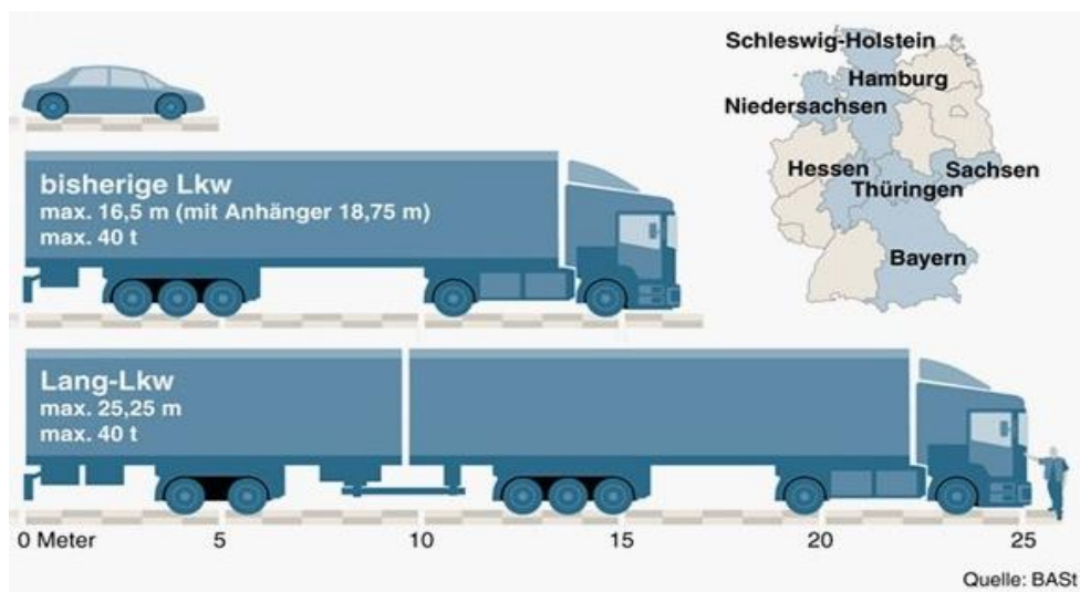
Obrázek 20 Porovnání tahače s návěsem a Eurokombi soupravou
