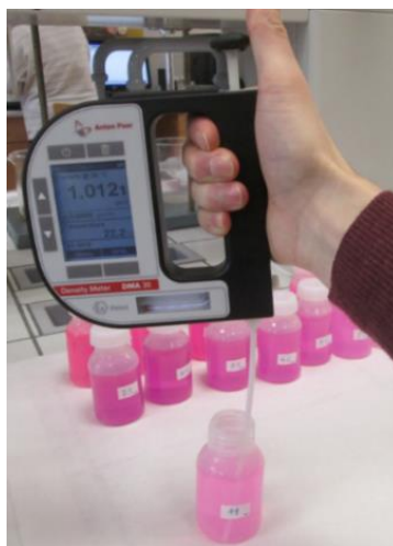
Obrázek 17: Měření hustoty přístrojem Anton Paar DMA 35 Basic
