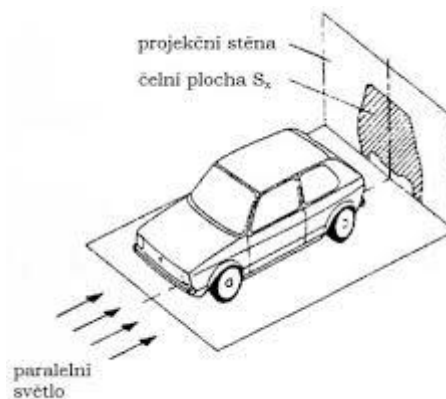
Obrázek 22 – Výpočet čelní plochy vozidla pomocí projekce [8 s. 27]
