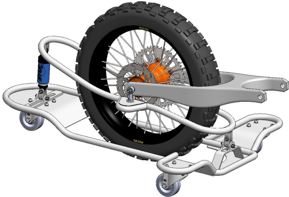
Obr. 31 – Umístění sestavy rámu zadního kola
