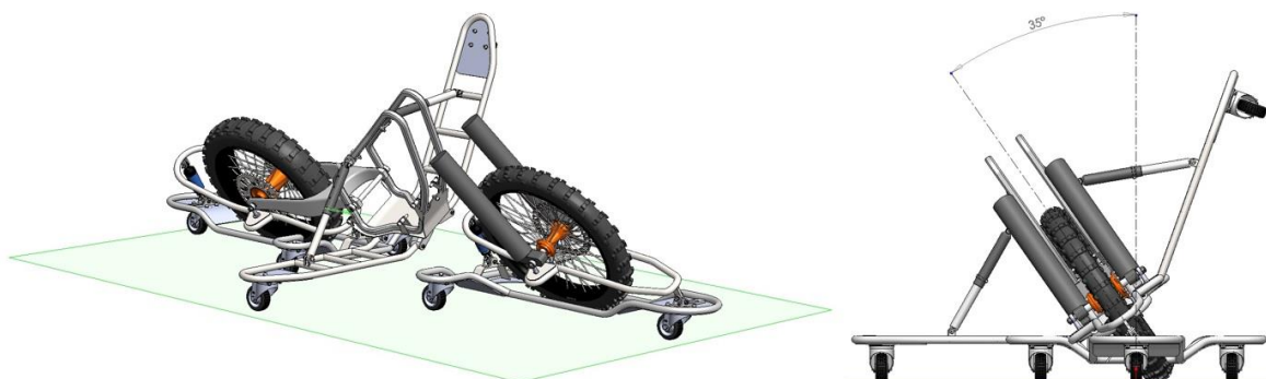
Obr. 52 – Minimální boční náklon 35°
