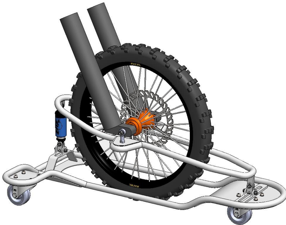
Obr. 24 – Umístění sestavy rámu předního kola
