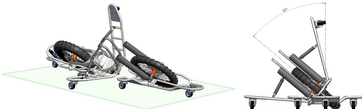
Obr. 53 – Maximální boční náklon 50°
