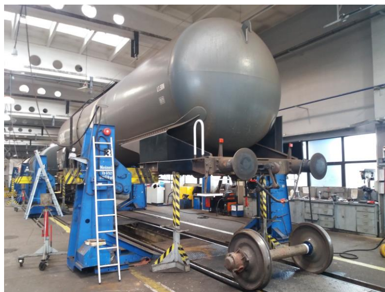
Obr. 2 Opravna vozů vybavená patkovými zvedáky, foto: autor
