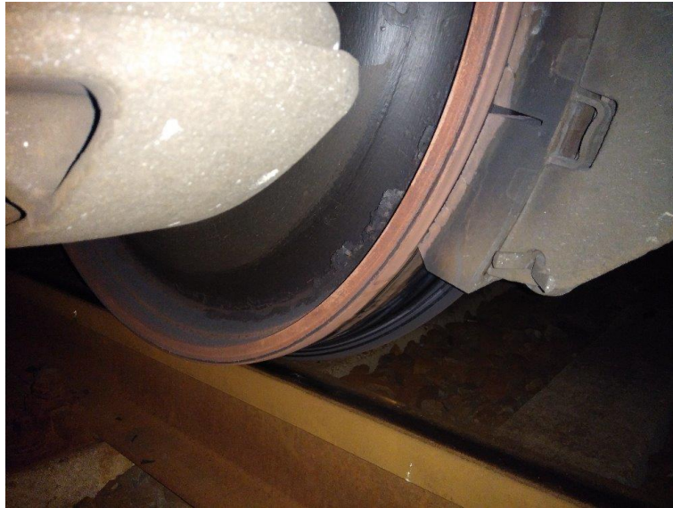
Obr. 12 Závada 1.2.2. Tepelné vyhrátí účinkem brzdy, foto: archiv autora
