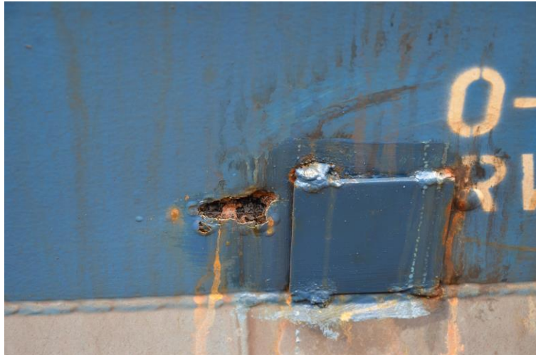
Obr. 18 Závada 6.1.4.2 Stěna poškozená s rizikem ztráty zboží, foto autor
