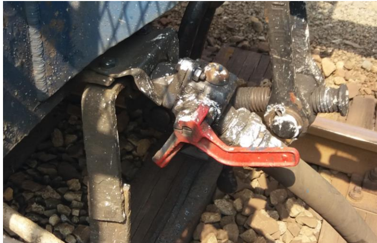
Obr. 14 Závada 3.3.5. Brzdový kohout nelze otevřít do krajní polohy, foto: archiv autora
