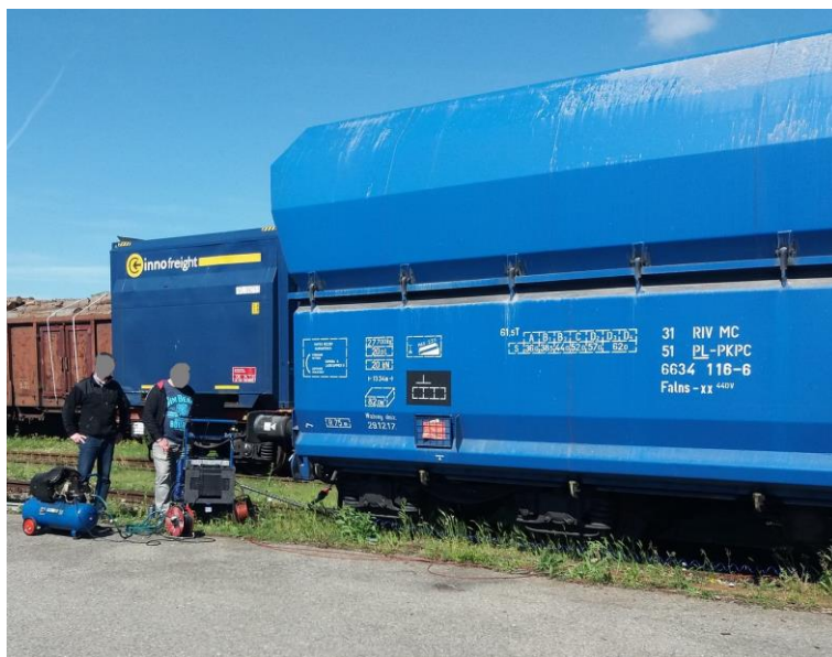
Obr. 13 Zkouška brzdy na zkušebním stavu, foto: autor
