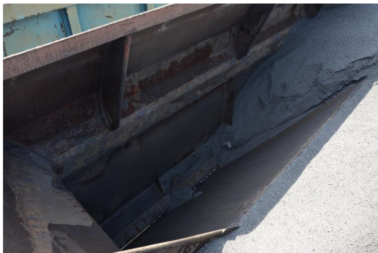
Obr. 17 Důsledky netěsnosti bočních klapek u vozu řady Fals, typ 9-402.1, foto: autor
