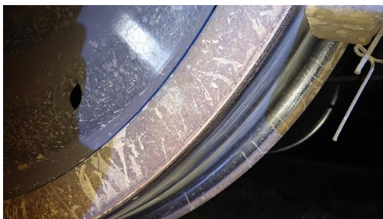
Obr. 11 Závada 1.1.4. Kontrolní značky nejsou jednoznačně zřetelné, foto: archiv autora
