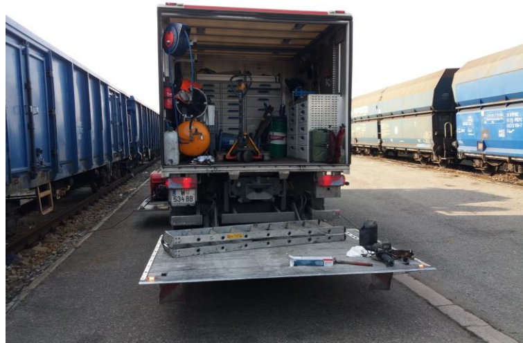
Obr. 1 Vybavení pojízdné dílny společnosti ÖBB-Technische Services GmbH, foto: autor
