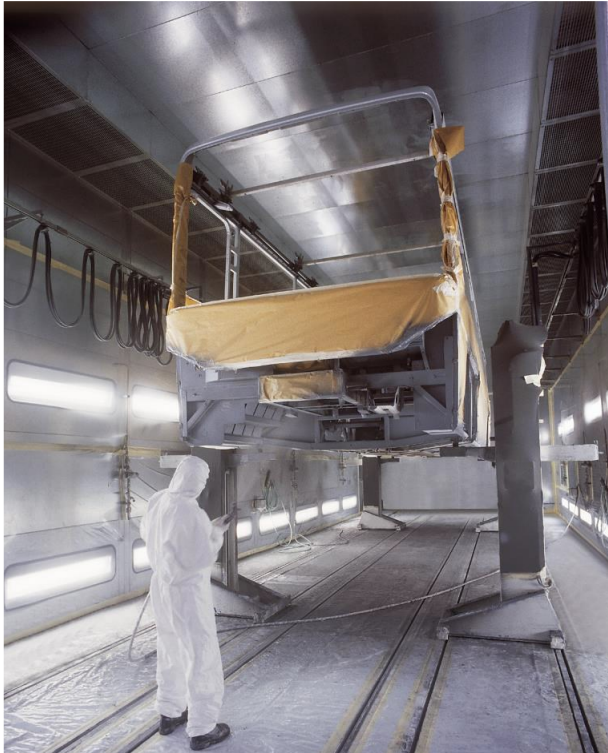
Obrázek 9 Skelet autobusu po nastříkání podvozku „UBS“ (IVECO, 2019e)
