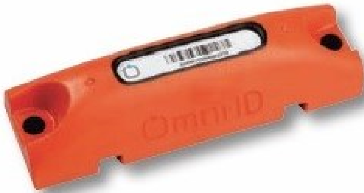
Obrázek 1 Vysoce odolný aktivní RFID tag (Klauz, 2017)
