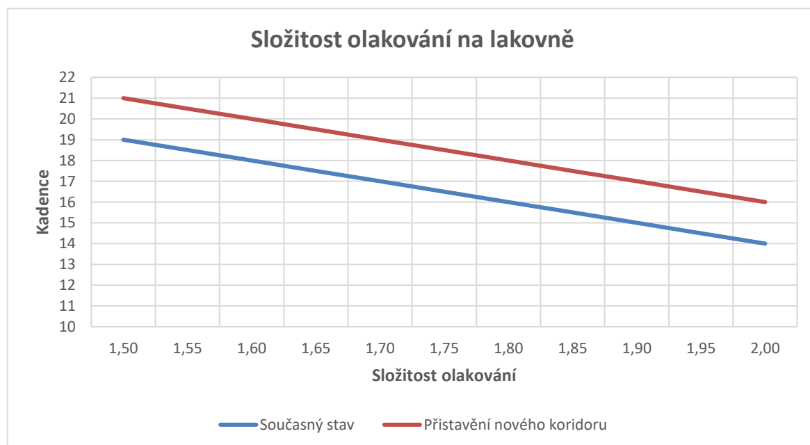
Obrázek 2 Koeficient obtížnosti olakování (IVECO, 2019 – upraveno autorkou)
