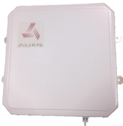
Obrázek 24 Alien anténa typ ALR-9698-C (Codeware, 2019)
