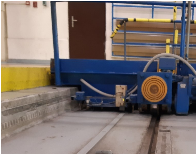
Obrázek 6 Žlab pro přesuvnu na lakovně (Autorka)
