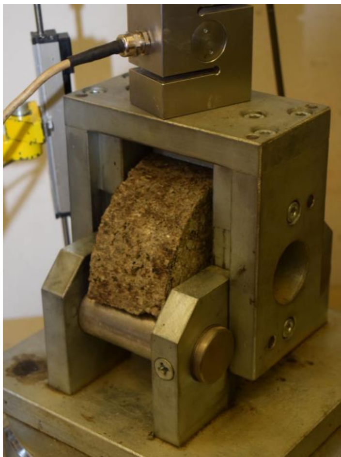
Obrázek 32 – Detail provedení zkoušky šíření trhliny ohybem
