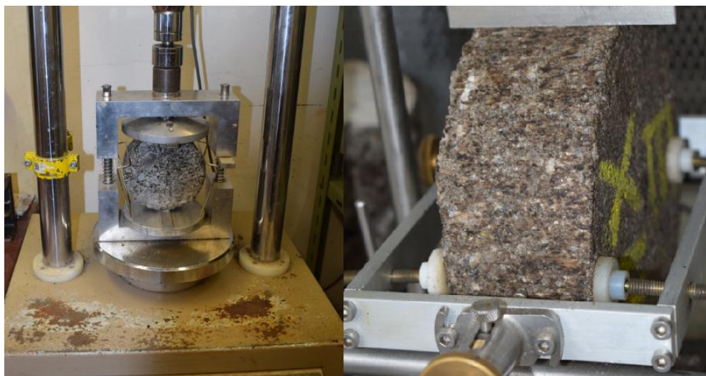
Obrázek 29 - Zkouška modulu tuhosti v NATu
