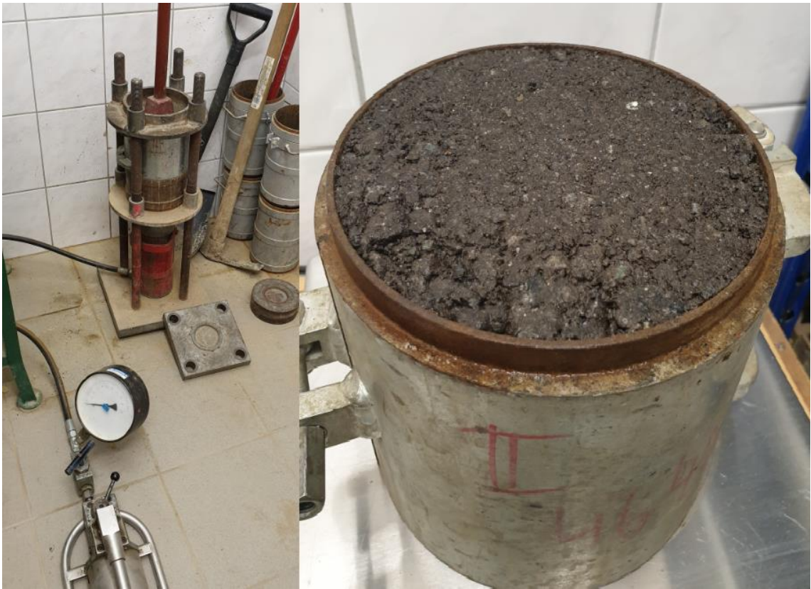
Obrázek 21 - Ruční hydraulický lis (vlevo); Vyhotovené zkušební válcové těleso pro zkoušku pevnosti v příčném tahu (vpravo)
