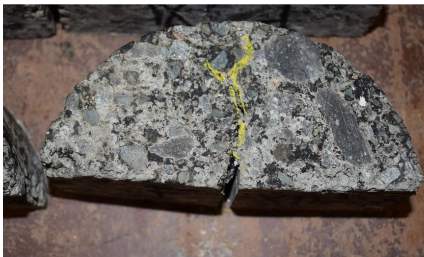
Obrázek 31 – Detail porušení zkušebního půlválcového tělesa ohybem - směs F
