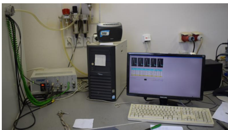
Obrázek 30 - Výpočetní technika pro stanovení modulu tuhosti v NATu
