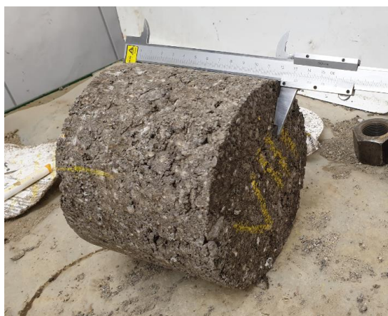
Obrázek 25 - Stanovení rozměrů zkušebních těles posuvným měřítkem
