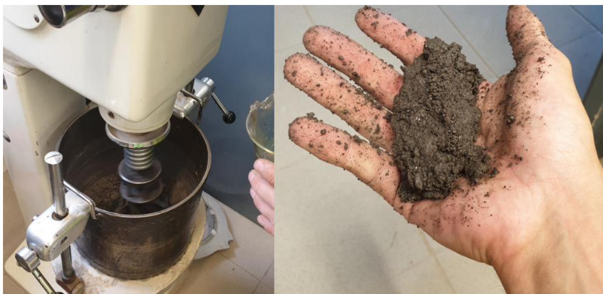
Obrázek 17 - Mísení směsi v laboratorní míchačce (vlevo); Ověření optimální vlhkosti metodou koule (vpravo)
