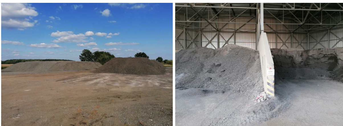
Obrázek 25 – R-materiál volně ložený netříděný ve srovnání s tříděným R-materiálem [1]
