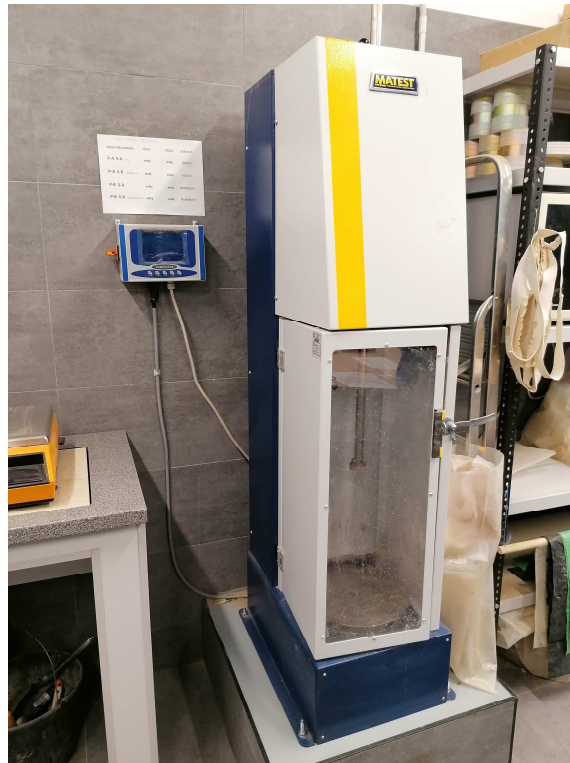
Obrázek 33 – Automatický přístroj pro výrobu těles dle Proctorovy zkoušky [1]
