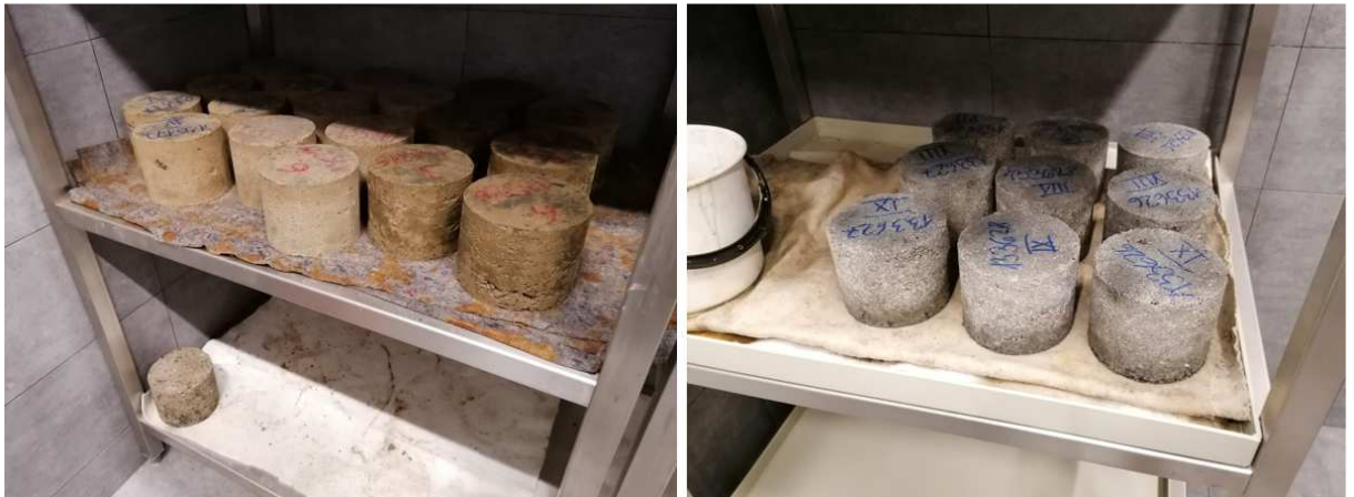
Obrázek 40 – Zkušební tělesa během nasycování u zkoušky odolnosti proti mrazu a vodě [1]
