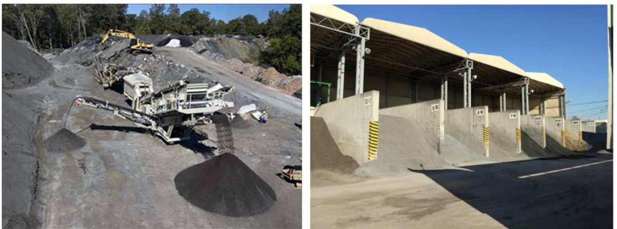
Obrázek 15 – Třídění a skladování R-materiálu [16]
