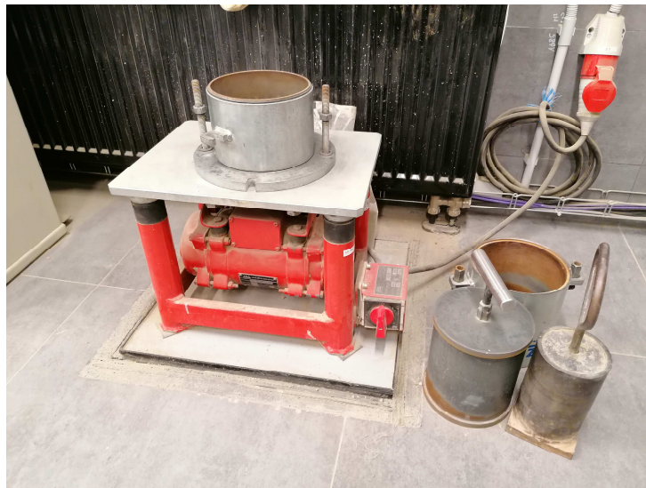
Obrázek 35 – Vibrační stůl se zatěžovacími trny [1]
