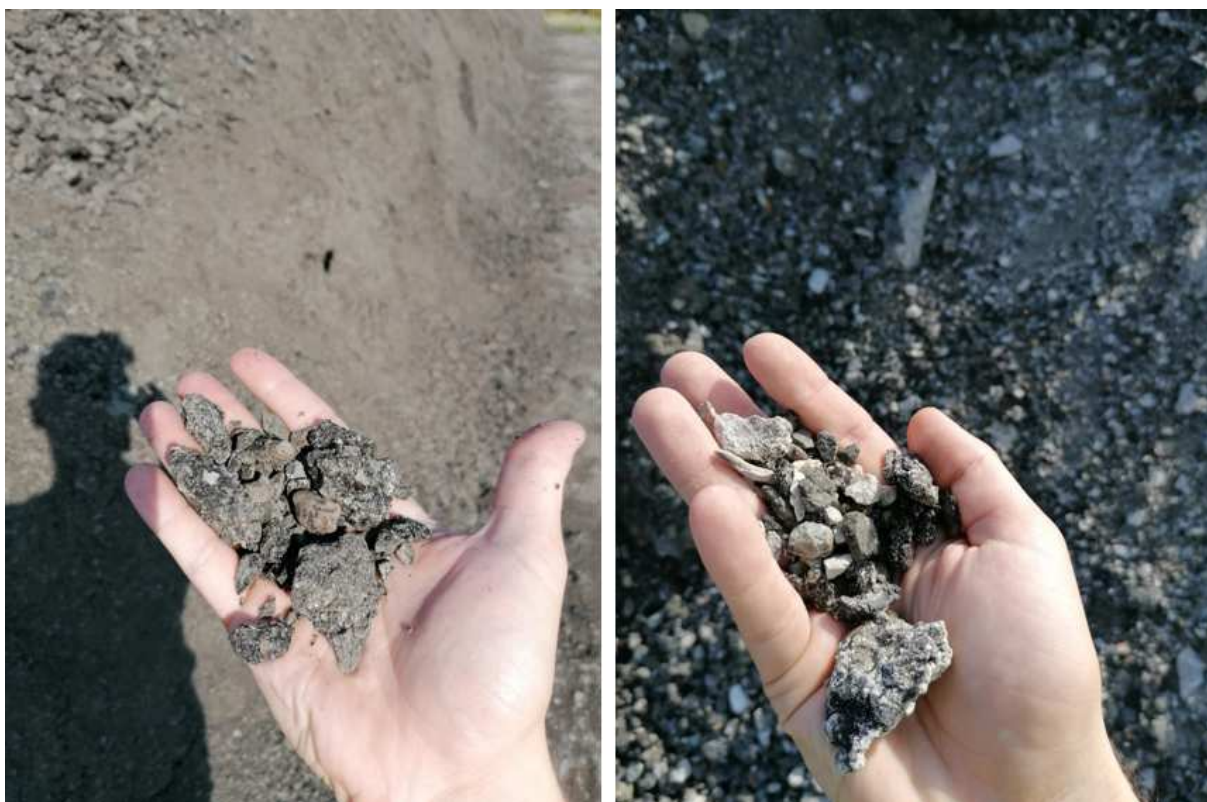
Obrázek 41 –Zleva čistý R-materiál a vpravo s příměsí betonové stabilizace cementem [1]
