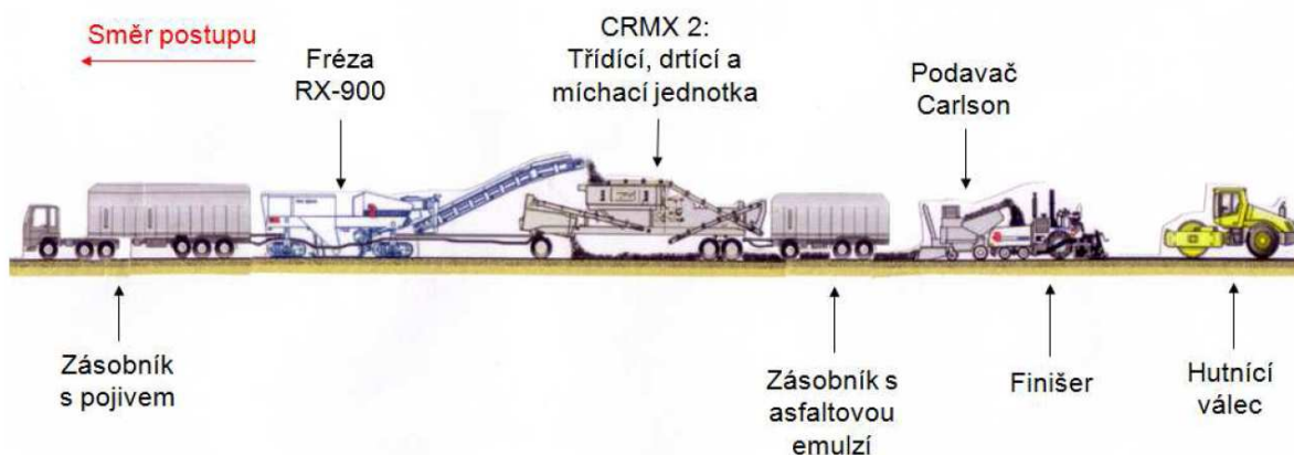
Obrázek 16 – Sestava strojů recyklačního vlaku s nasazením silniční frézy RX-900 [13]
